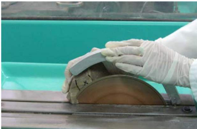
Ilustración 5 Corte de una muestra de roca utilizando una sierra de diamante para la preparación de láminas delgadas.
