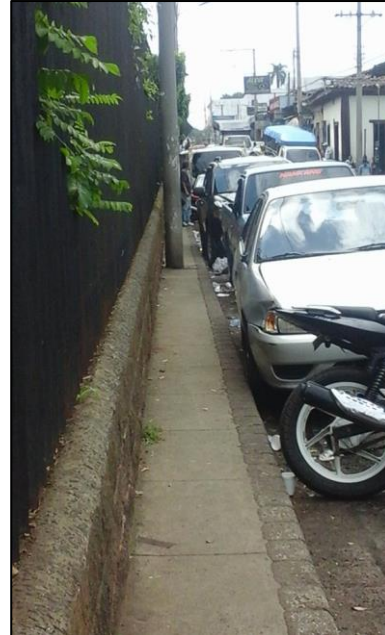
Las aceras que conduce a la entrada del portón de emergencia, no cumplen con el ancho mínimo.
