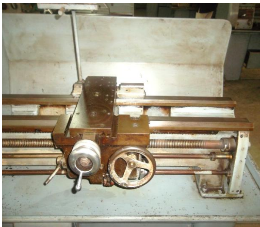
Figura #59: Palanca de accionamiento.
