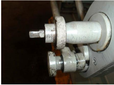
Figura #72: Tornillo para seleccionar recorrido del avance automático.
