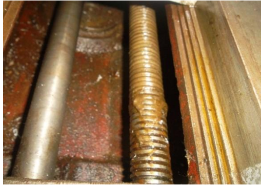
Figura #62: Tornillos de la mesa transversal.
