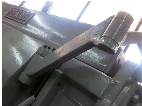
Figura #61: Cabezal o bastidor de la fresadora.
