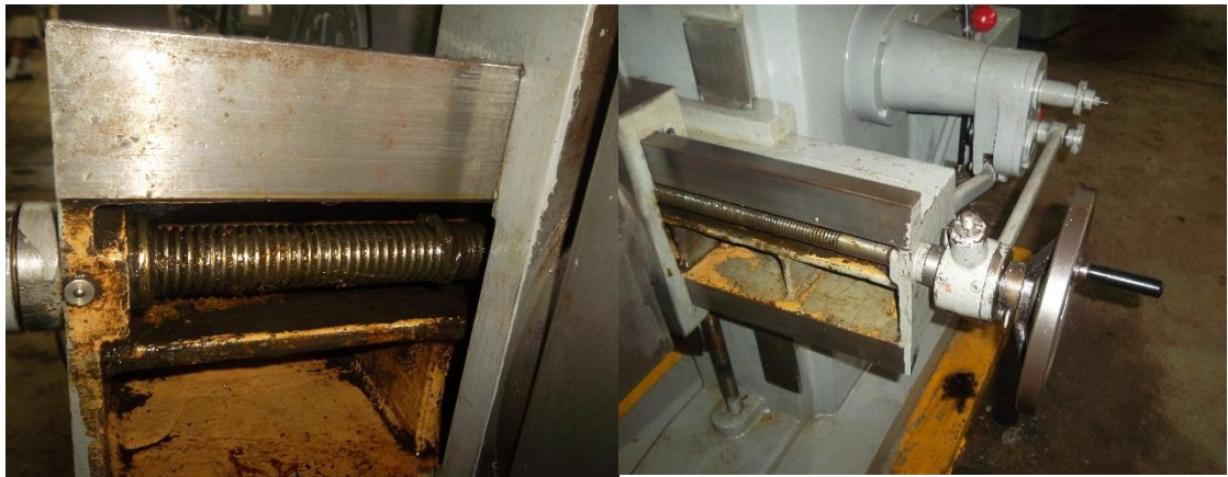
Figura #71 Guía de deslizamiento.
