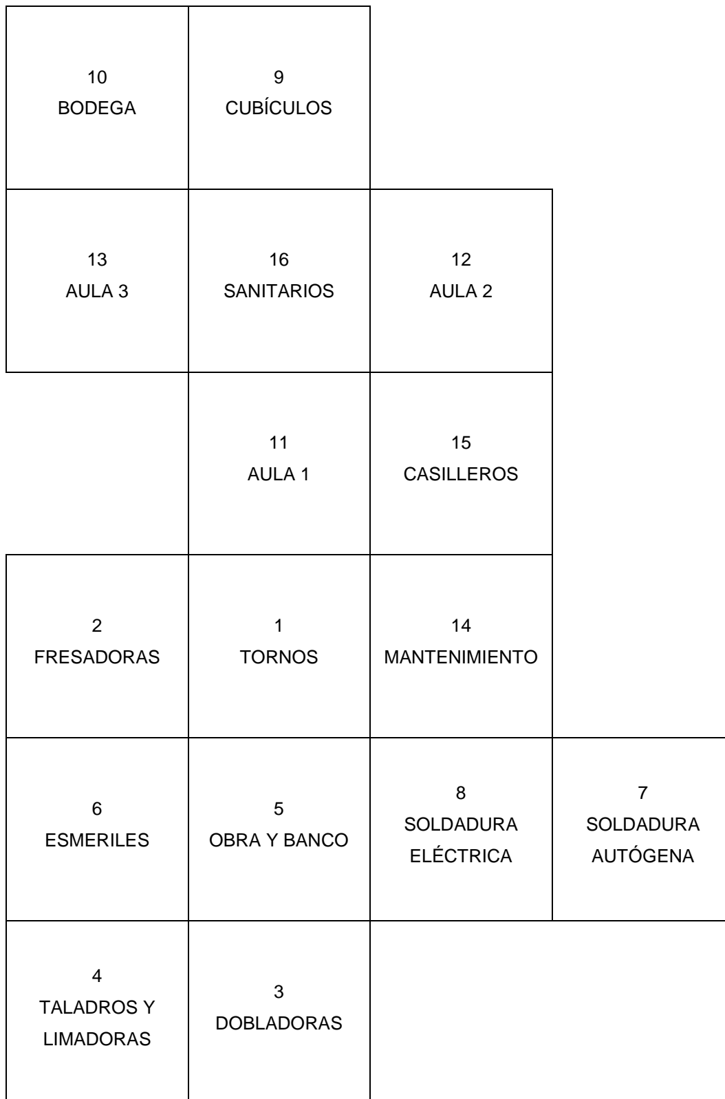
Figura #8: Diagrama adimensional de bloques (Ordenamiento básico).
