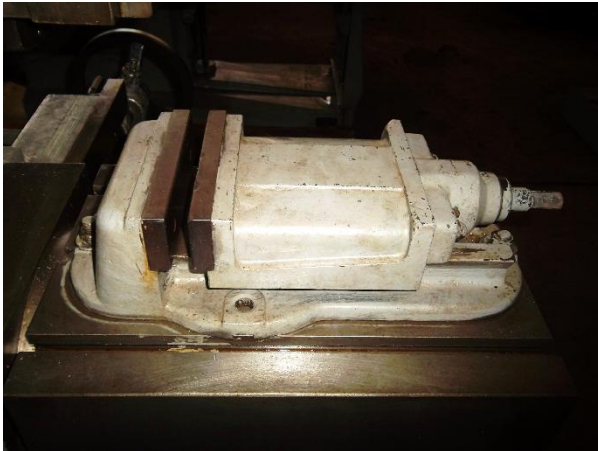
Figura #68: Prensa de sujeción de herramientas.
