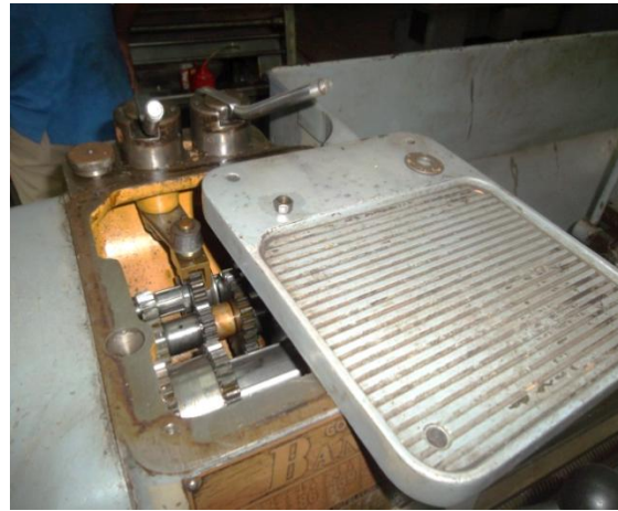
Figura #51: Cabezal fijo.
