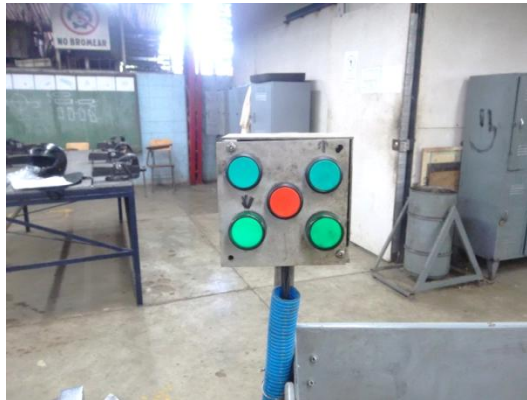
Figura #50: Botones de mando de encendido y palancas de accionamiento.
