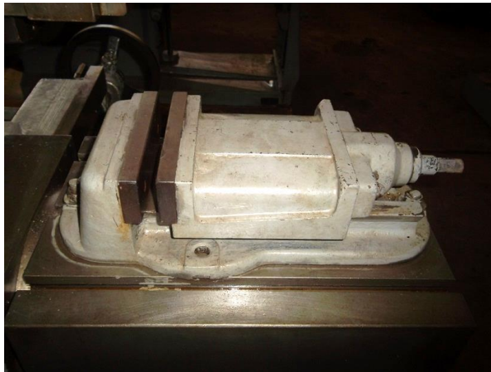
Figura #65: Prensa de sujeción.
