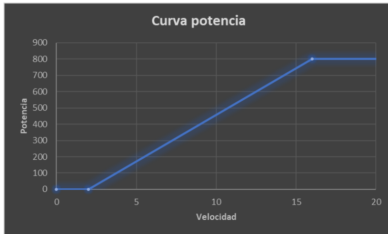
Figura n.º 4.2 Curva de Potencia-Velocidad de Egenwaywind, Fuente: Propia.
