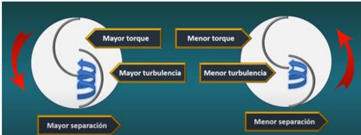
Figura n.º 1.7 Relación de Torque-Turbulencia en un Aerogenerador de eje vertical.
