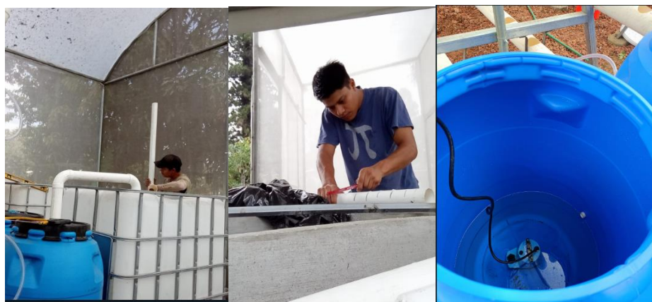
Figura 9. Elaboración de sistema de biofiltración para la colonización de bacterias nitrificantes
