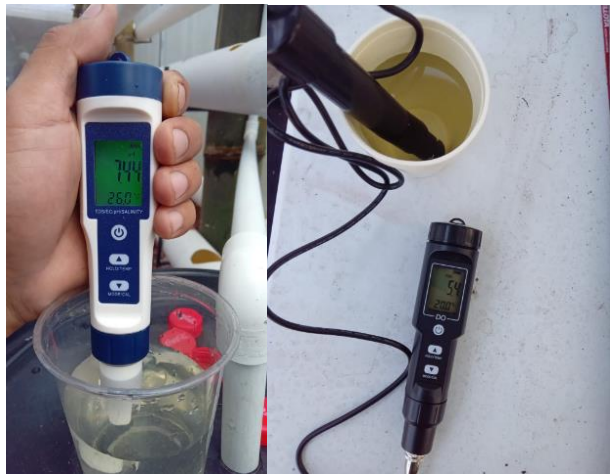
Figura 43. pHmetro y medidor de Oxígeno Disuelto para toma de parámetros del agua.
