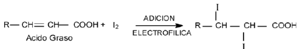
Figura N° 7. Fórmula para determinación del índice de yodo en aceites y grasas comestibles 2
