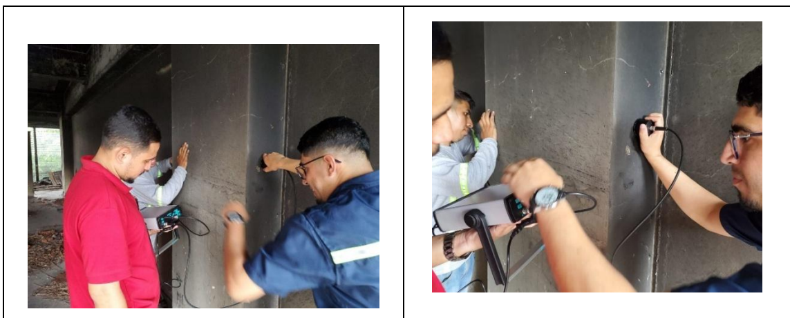
Imagen 56. Implementación de ensayo: Velocidad de pulso ultrasónico. fuente: propia.
