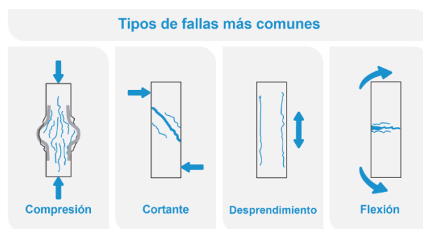
Imagen 7. Daños en columnas
