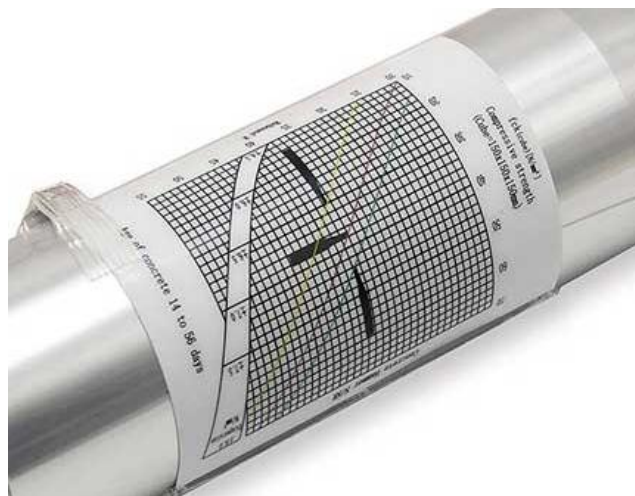
Imagen 15. Correlación típica de martillos de rebote.
