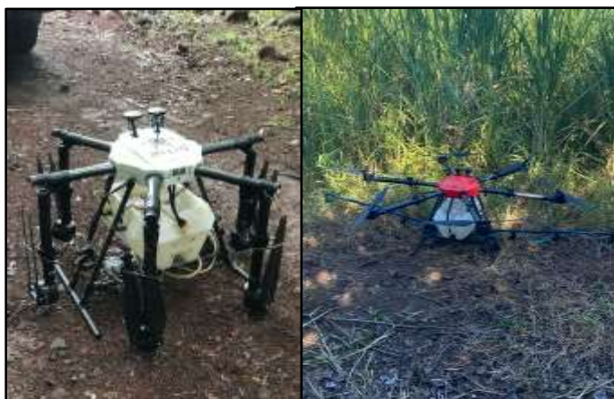
Imagen 12. VANT Hylio® AG116 descargado y listo para plegar brazos y armar helices.
