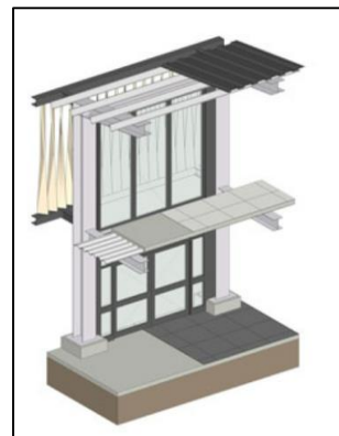
FIG 5. Representa un modelo preciso para producción y montaje, con detalles técnicos completos. Fuente: Bimexp - LOD
