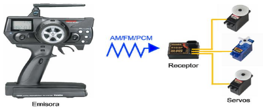
Figura 61. Recepción y distribución de pulsos PWM para controlar servos [9] .
