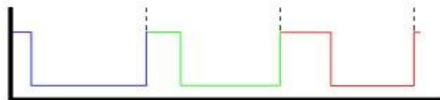
Figura 56. PWM para recorrer todo el rango de operación del servo [9] .
