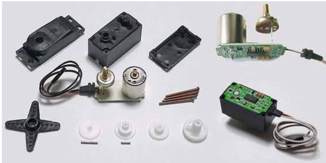
Figura 55. Componentes de un servo: carcasa; motor DC; potenciómetro; circuito de control; tren reductor; brazo (elemento terminal en el eje)
