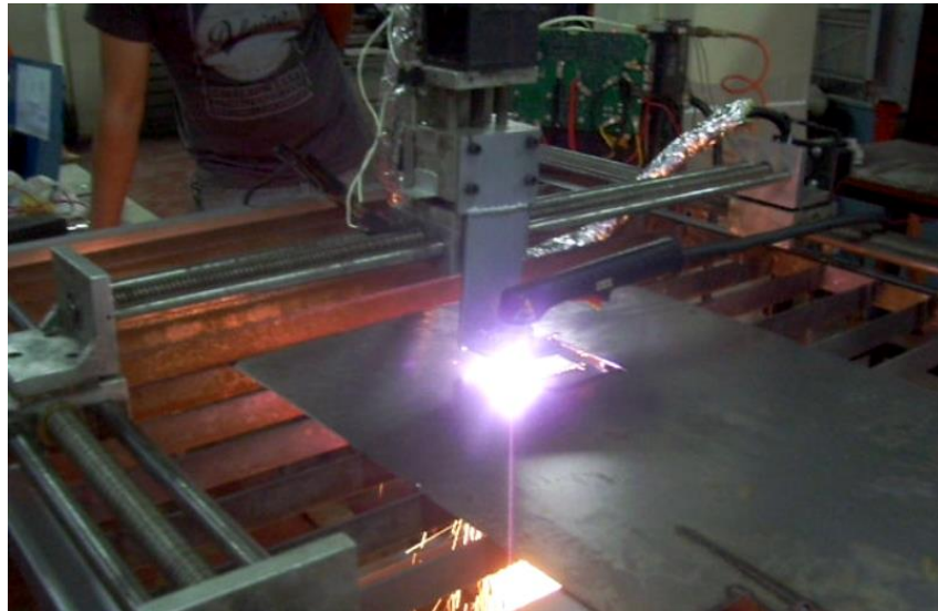
Figura 129. Vista el arco al momento del corte.
