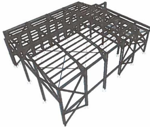
Imagen N° 4: Estructura metálica de nave en 3D.
