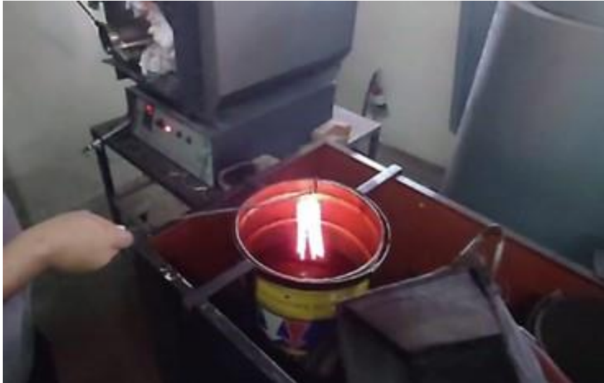
Fig. 2.13. Instantes antes de sumergir las probetas por completo en aceite.
