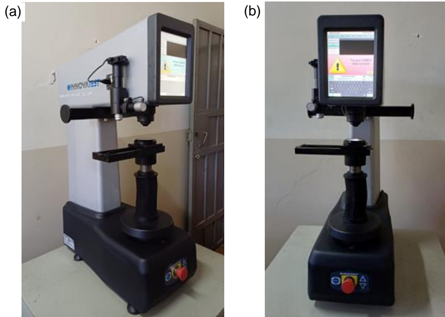
Fig. 2.24. Máquina de ensayo de microdureza Innova-test, modelo VERZUS 750CCD: a) Vista lateral, donde se aprecian el diseño y los componentes principales; y b) vista de perfil, mostrando la interfaz y la zona de ensayo.
