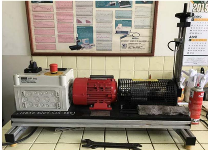
Fig. 2.16. Máquina para ensayos de fatiga por flexión rotativa marca GUNT modelo WP 140 [33].
