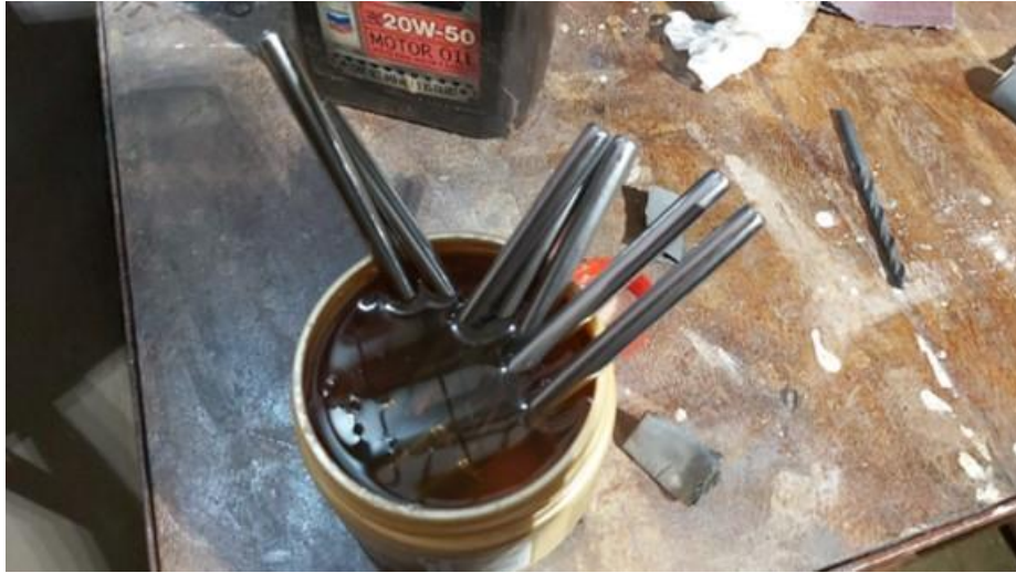
Fig. 2.15. Probetas lijadas hasta 1,500 con acabado tipo espejo sumergidas en aceite.
