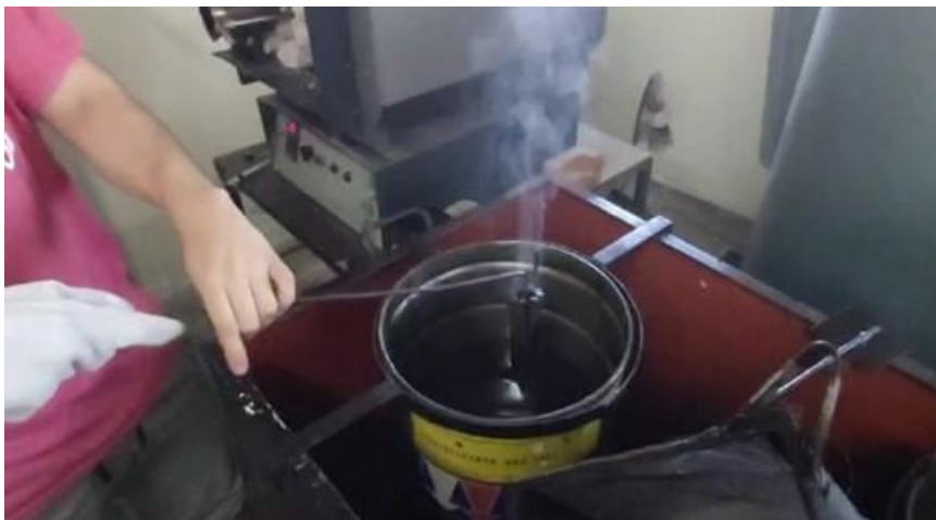
Fig. 2.14. Tratamiento térmico de revenido en probetas a 200 °C.
