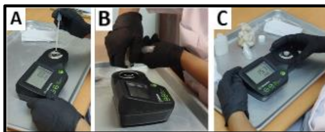
Figura 10. Medición de grados brix en la pulpa de cacao. (A) Calibración del brixómetro, (B) extracción de jugo de pulpa, (C) toma de lectura.
