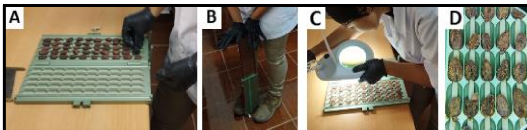
Figura 13. Prueba de corte de granos de cacao con guillotina. (A) Colocación de granos; (B) corte de granos; (C) observación de granos y (D) granos bajo lente magnificador.
