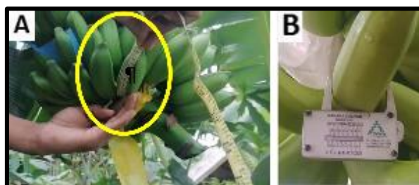
Figura 8. Mediciones de calidad del plátano. (A) Longitud del fruto y (B) diámetro del fruto.
