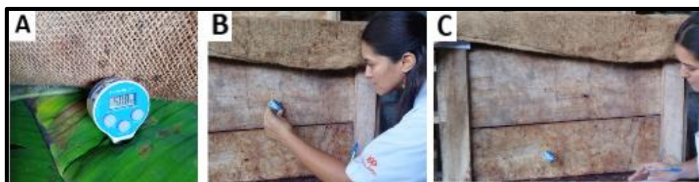
Figura 6. Medición de temperatura interna del batch . (A) Temperatura superficial, (B) temperatura al medio del cajón, y (C) temperatura al fondo del cajón.
