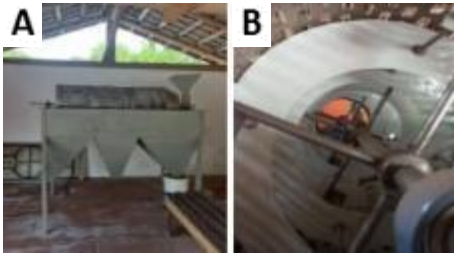
Anexo A-6. Máquina cribadora para cacao. (A) Parte exterior. (B) Parte interior.
