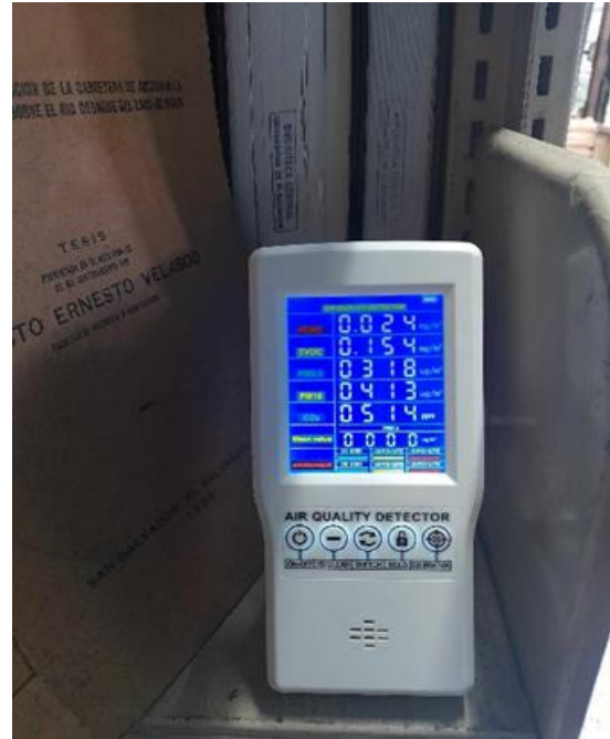
Figura N°65. Mediciones de MP2.5 Y MP10 en Biblioteca Central
