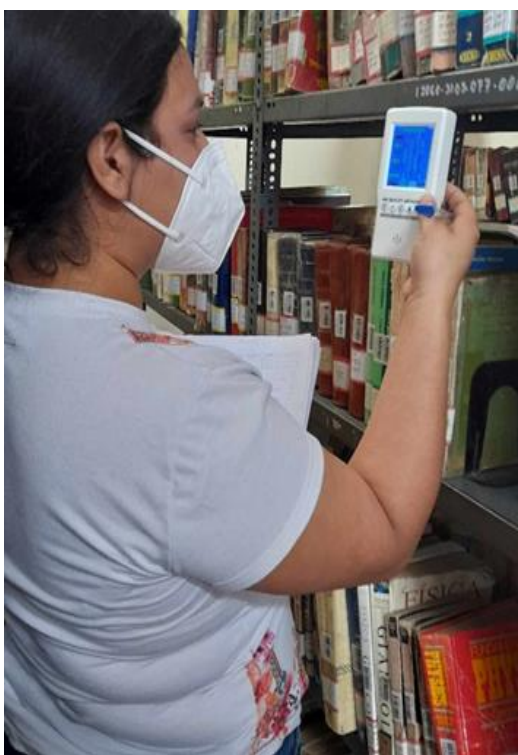
Figura N°60. Medición de MP2.5 y MP10 en los puntos de muestreo establecidos.
