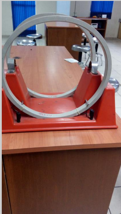
Figura 4 Laboratorio 3 bobinas de Helmontz para medir el campo magnético de la tierra
