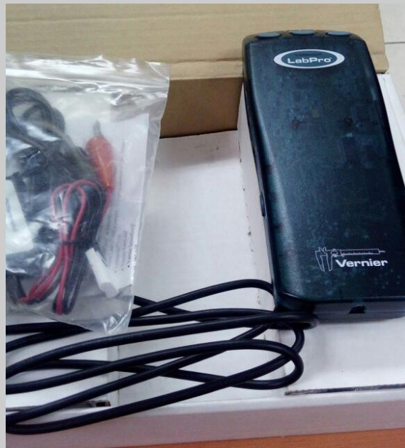
Figura 3 Laboratorio 2 Vernier que mide de manera computarizada la descarga de capacitor
