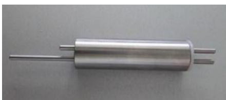
Figura N° 2. Sifón de metal con dos tubos, uno largo y otro corto.
