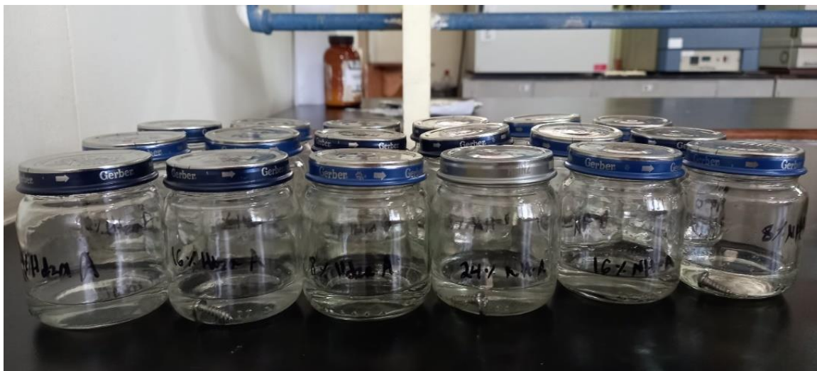
Figura 4.14 Prueba de corrosión de las soluciones salinas no electrolizadas y electrolizadas.
