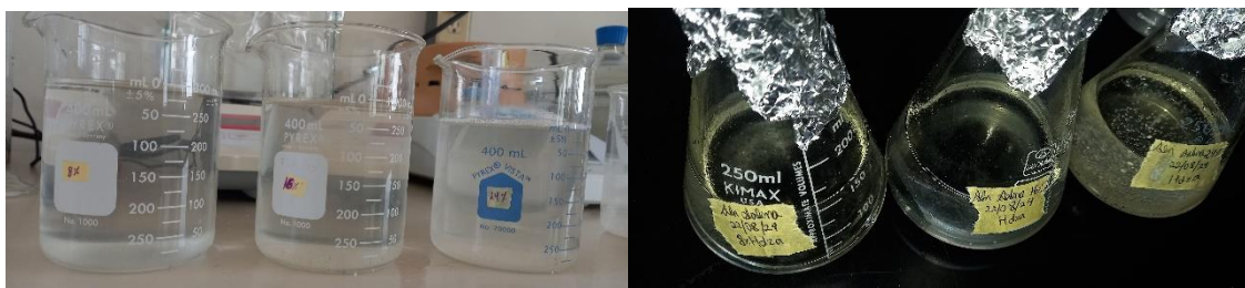
Figura 4.1 Soluciones salinas no electrolizadas (izquierda) y electrolizadas (derecha).
