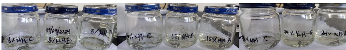
Figura 4.15 Tornillos dentro de las soluciones no electrolizadas después de 30 días.
