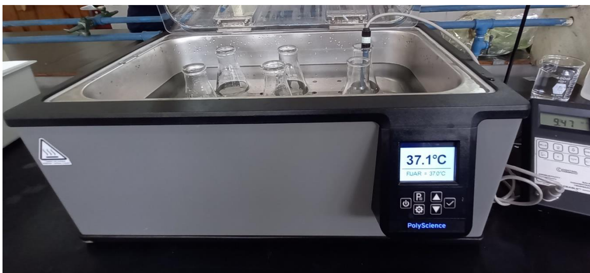
Figura 4.5 Baño María para la evaluación de las soluciones a tres temperaturas: ambiente, 37 y 45 grados centígrados.
