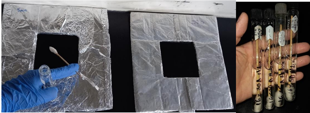
Figura 4.9 Ejemplificación del proceso de hisopado.
