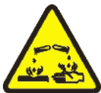
Figura 13. Advertencias sobre reactivos corrosivos.
