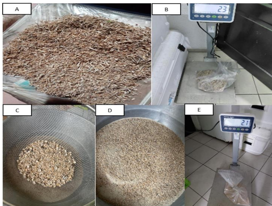
Figura 4 Proceso de elaboración de la harina de espinas de pescado mediante secado solar y molienda. A) secado solar de las espinas de pescado para la reducción del contenido de humedad, B) determinación del peso de las espinas después del proceso de secado, C) tamizado de las espinas molidas para separar fragmentos de mayor tamaño, D) producto final correspondiente a la harina de espinas de pescado, E) determinación del peso final de la harina obtenida.
