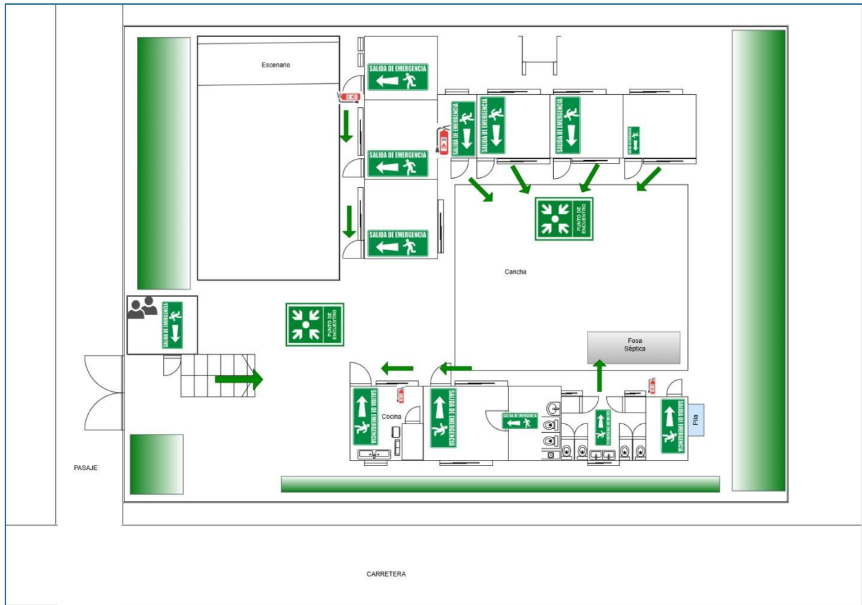
Figura N° 3 Plano de ruta de evacuación.
