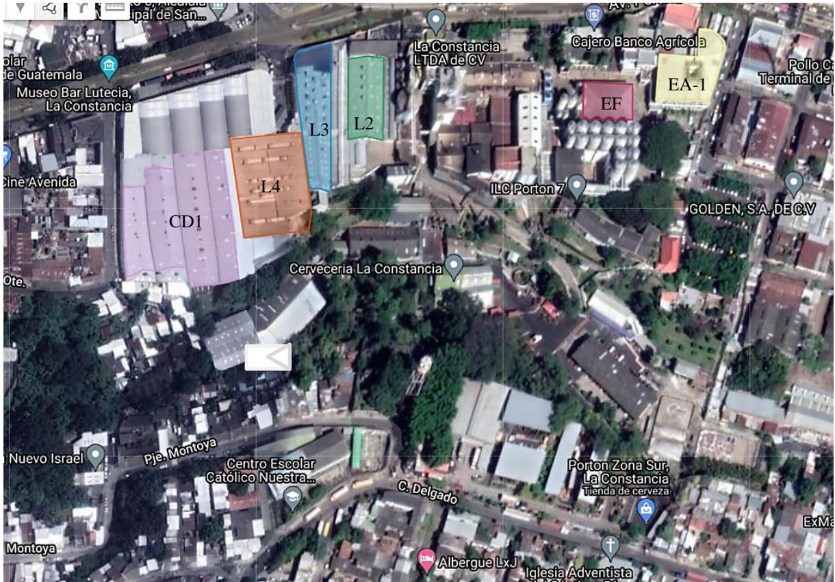
Figura 21 Áreas identificadas con potencial para montaje de tecnología para aprovechamiento de la radiación solar. EA: Edificio Administrativo; EF: edificio sala filtro; L2: edificio de línea dos de producción; L3: edificio de línea tres de producción; L4: edificio de línea cuatro de producción; CD1: edificio de producto terminado. Ref.: Elaboración propia.
