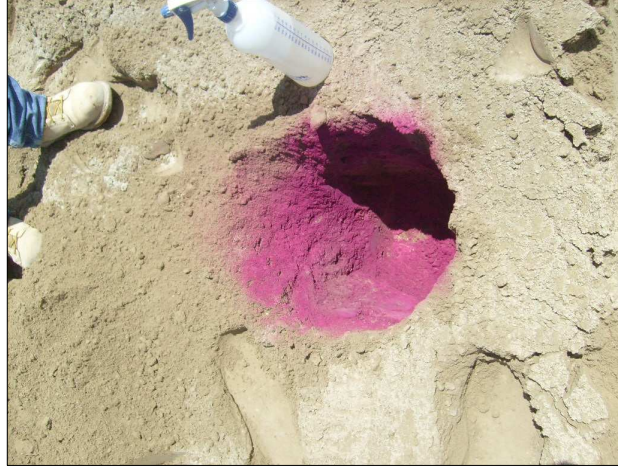
Fotografía 5.11 Colocación de fenolftaleína en mezcla suelo-cal
