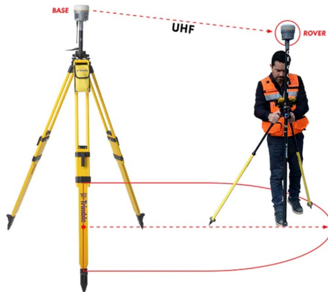
Imagen No. 5 - 2. Distribución de equipos en la técnica de medición RTK-UHF.
