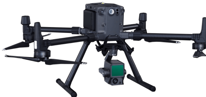
Imagen No. 7 - 7. Matrice 300 RTK + Zunmuse L1.
