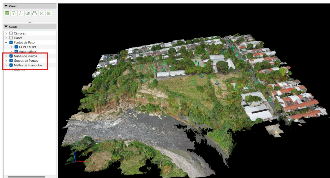
Imagen No. 13 - 33. Visualización de nube densa de puntos y malla de triángulos.
