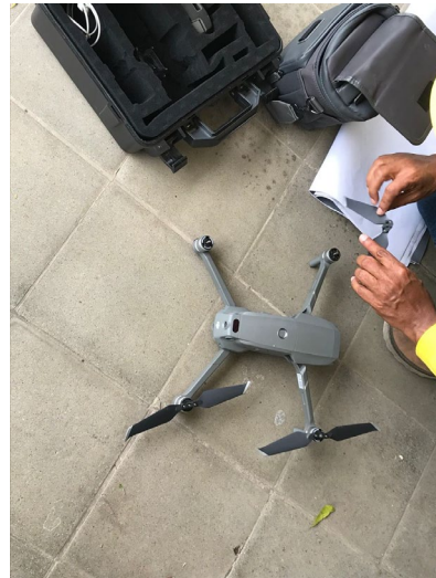
Imagen No. 12 - 7. Instalación de hélices de dron DJI Mavic 2 Pro.
