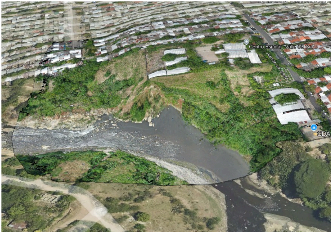
Imagen No. 13 - 40. Visualización de Ortomosaico generado por PIX4D en Google Earth Pro
