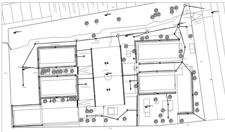
Imagen No. 15 - 3. Trazo de la red de drenaje de aguas lluvias en el CE Valle.
