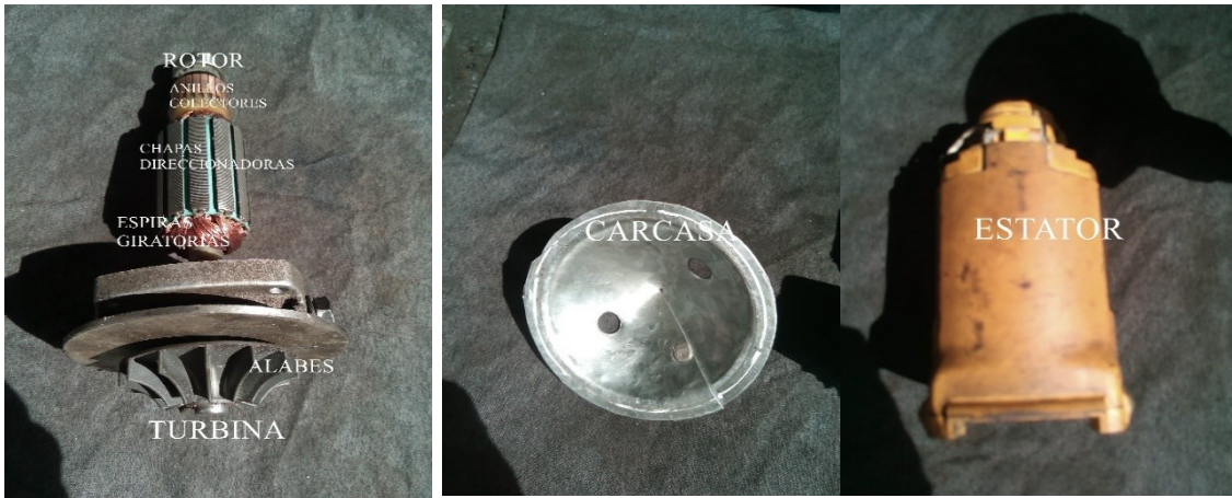
Figura 5.4. .Partes de la turbina alternador.
