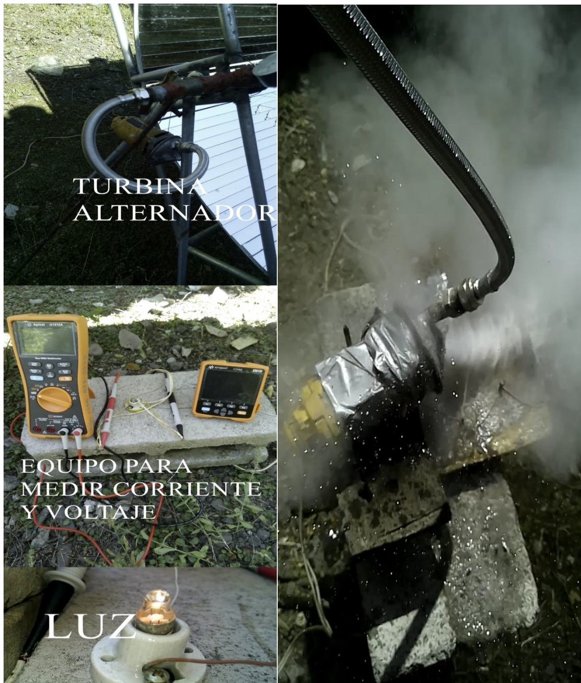
Figura 8.3. Montaje experimental y equipo de medición en los ensayos de producción de energía eléctrica.
