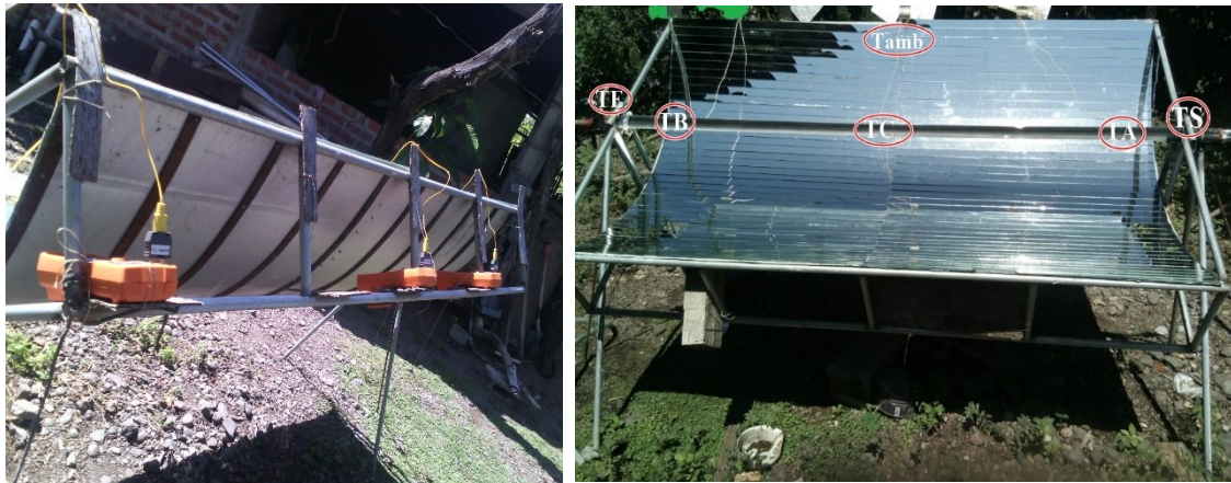
Figura 4.12. Puntos de medición de la temperatura en el tubo receptor.
