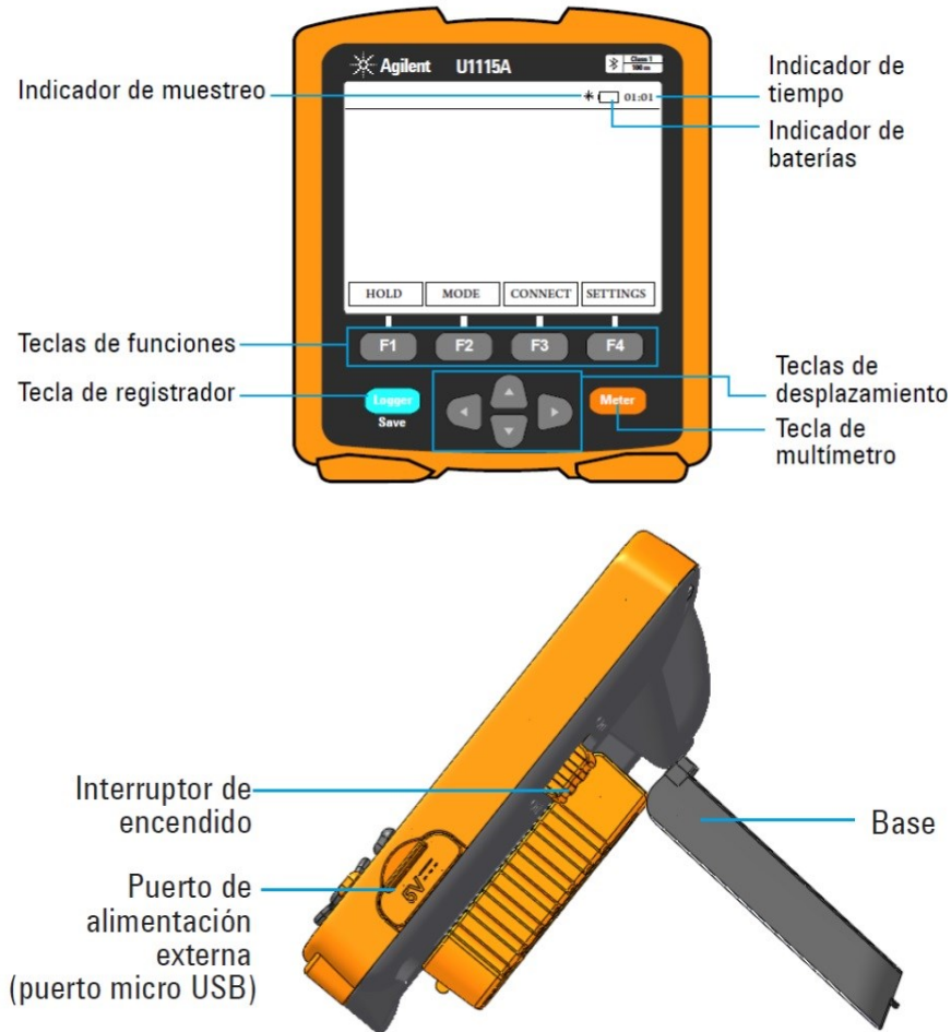
Figura 4.8. Equipo que almacena los datos de los multímetros digitales en tiempo real. (Keysight Technologies., 2015)
