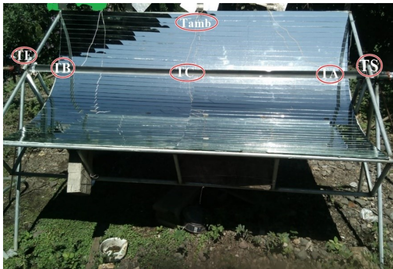
Figura 8.1. Montaje experimental para medir la temperatura en el tubo receptor sin fluido y con fluido.
