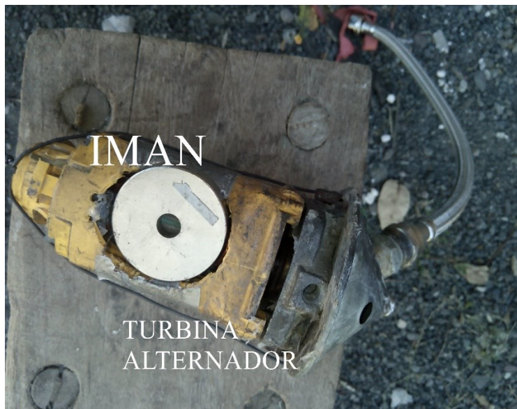
Figura 5.5. Turbina alternador completamente armado y listo para ensayar la generación de electricidad.
