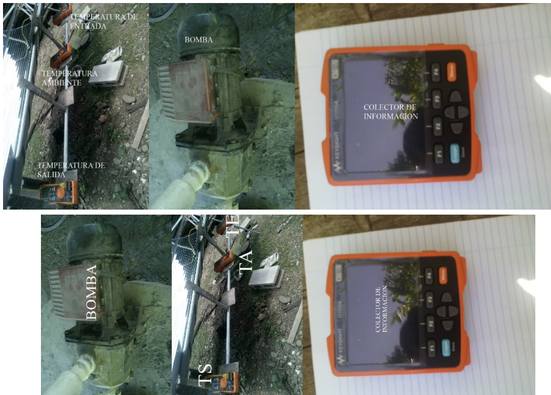
Figura 4.14. Montaje experimental para determinar la eficiencia óptica y térmica del CCP.
