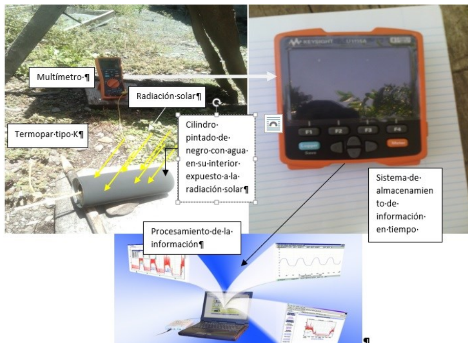
Figura 4.15. Montaje experimental para determinar el valor de la constante solar en la superficie terrestre.
