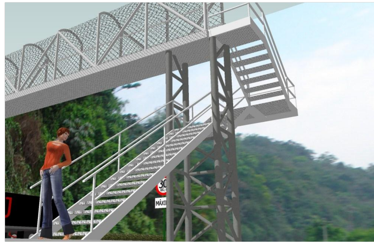
IMAGEN No. 3 Perspectiva de escaleras de pasarela peatonal.
