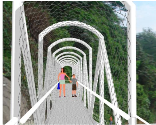
IMAGEN No. 4 Perspectiva del cerramiento de pasarela peatonal.
