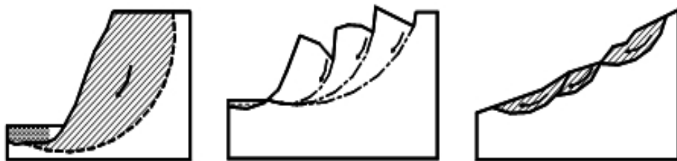
(1) Derrumbe Rotacional Simple (2) Derrumbe Rotacional Múltiple (3) derrumbe Sucesivo.
