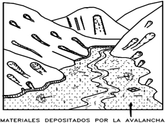
Figura 1.8.17 Avalancha en cauce de río por acumulación de materiales producto de una gran cantidad de deslizamientos ocurridos en el momento de un sismo.
