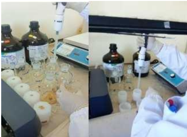
Figura 16. Procedimiento de desintegración de las muestras a través de la aplicación de ácidos.
