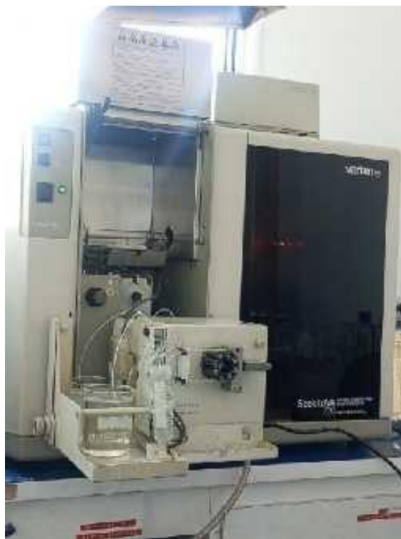
Figura 18. Realización de lecturas en el Espectrofotómetro AA con generador de hidruros, para análisis de mercurio, Laboratorio de absorción atómica, FUSADES.
