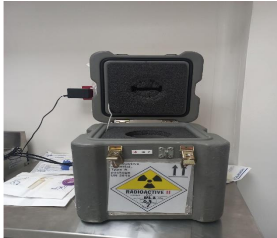
Figura 1. Contenedor de transporte de materiales radiactivos tipo “A”.
