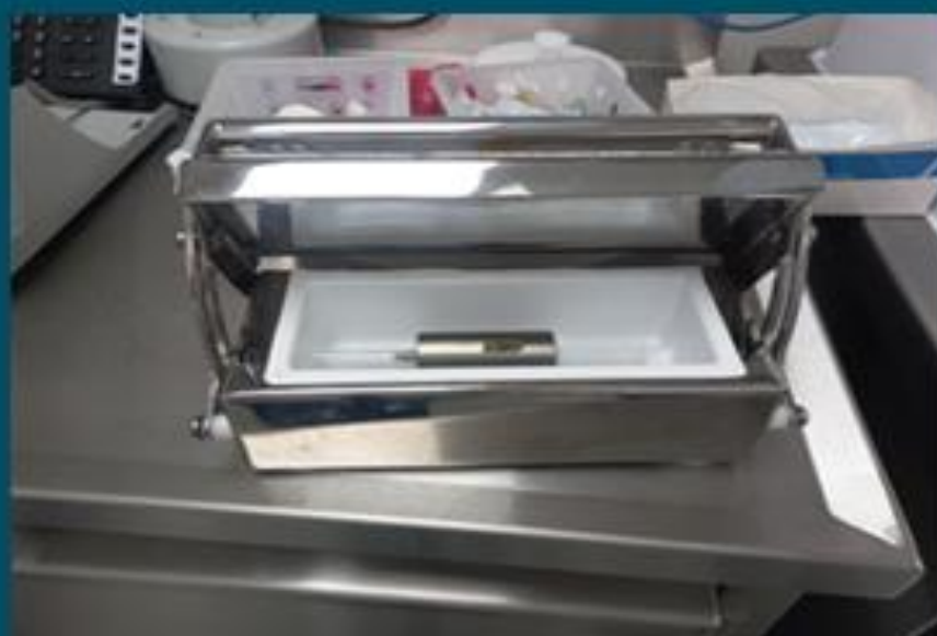
Contenedor blindado de tungsteno o plomo para transporte de viales o jeringa.
