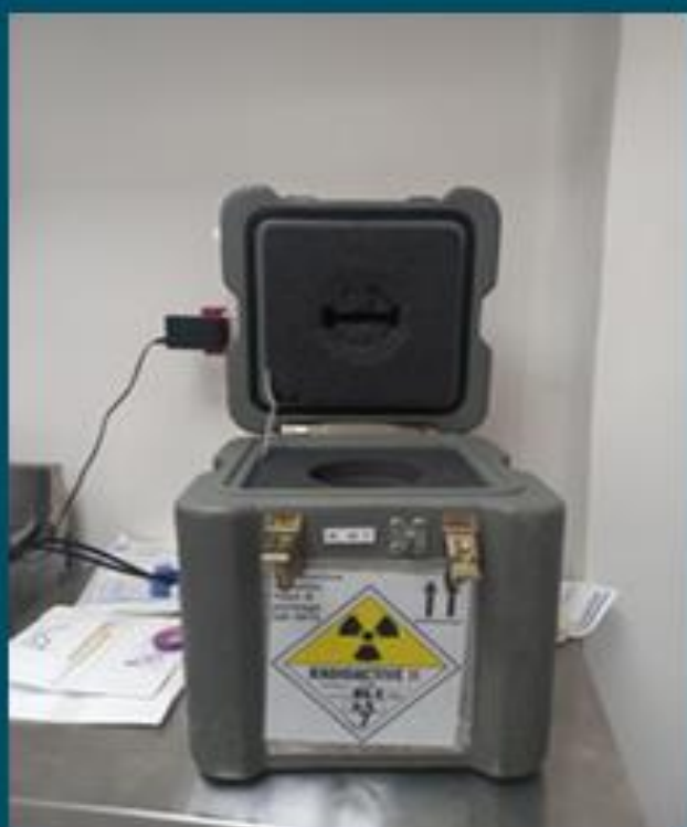
contenedor de transporte de materiales radioactivos tipo "A".
