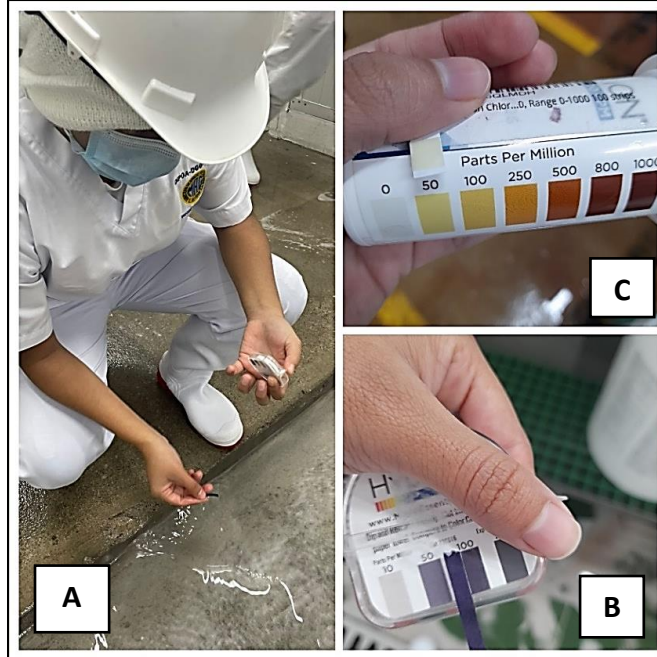
Figura A- 3. Registro de cloro en puntos de inspección del área fría. A= Registro de cloro en pediluvio B= Registro de cloro con tira reactiva con menor capacidad de ppm C= Registro de cloro con tira reactiva con menor capacidad de ppm
