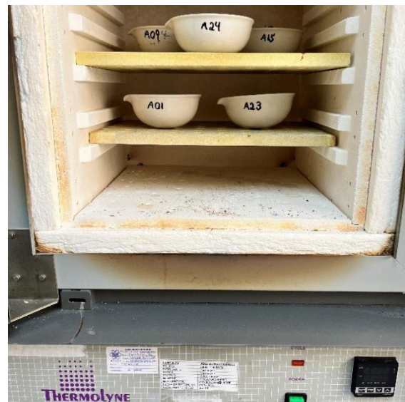
Figura 16. Disposición de muestras en el horno 30400 Thermolyne® para su respectivo secado.
