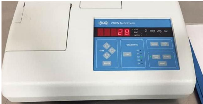
Figura 33. Equipo 2100N HACH® utilizado para el análisis de TURB.
