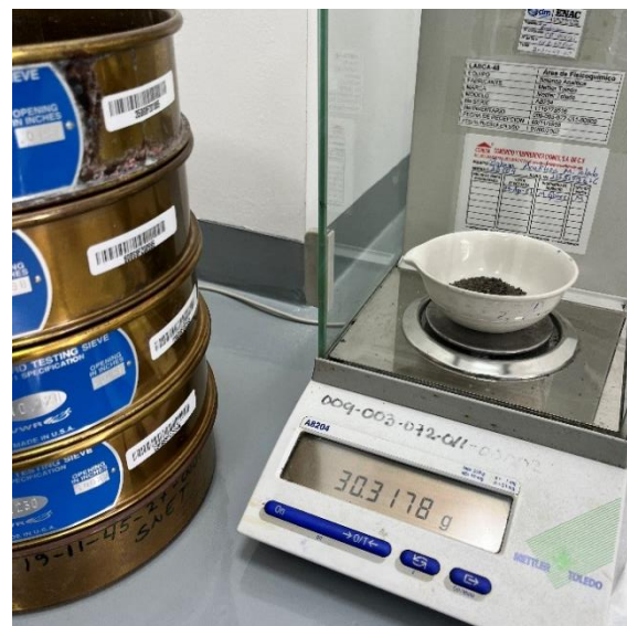
Figura 18. Balanza analítica AB204 Mettler Toledo® utilizada para el pesado de las fracciones de sedimentos.
