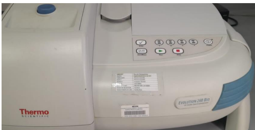
Figura 29. Equipo UV-VIS Evolution™ 260 BIO de Thermo Scientific™ utilizado para el análisis de NO 3 - y PO 4 3- .
