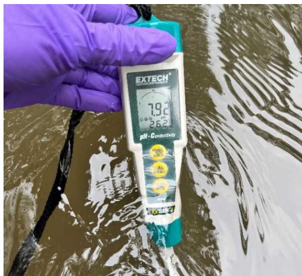
Figura 27. Multiparámetro Extech® EC500 utilizado para la medición de parámetros de campo.
