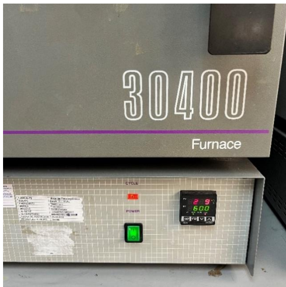
Figura 15. Horno 30400 Thermolyne® utilizado para el secado de las muestras a 60 °C.
