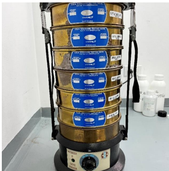
Figura 17. Tamices y mezclador Meinzer II™ utilizados para el análisis granulométrico.
