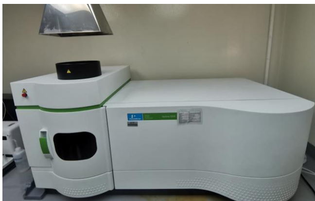
Figura 12. Equipo ICP Optima 8300 utilizado para la determinación de concentraciones de metales pesados.
