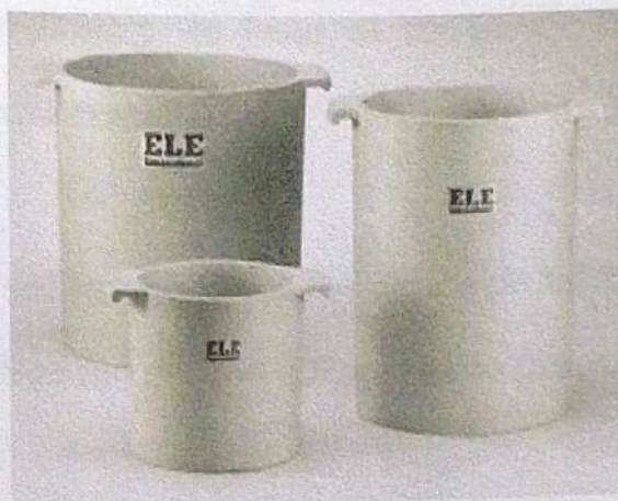
Figura 3.5. Depósitos medidores para realizar método de ensayo ASTM C 29.
