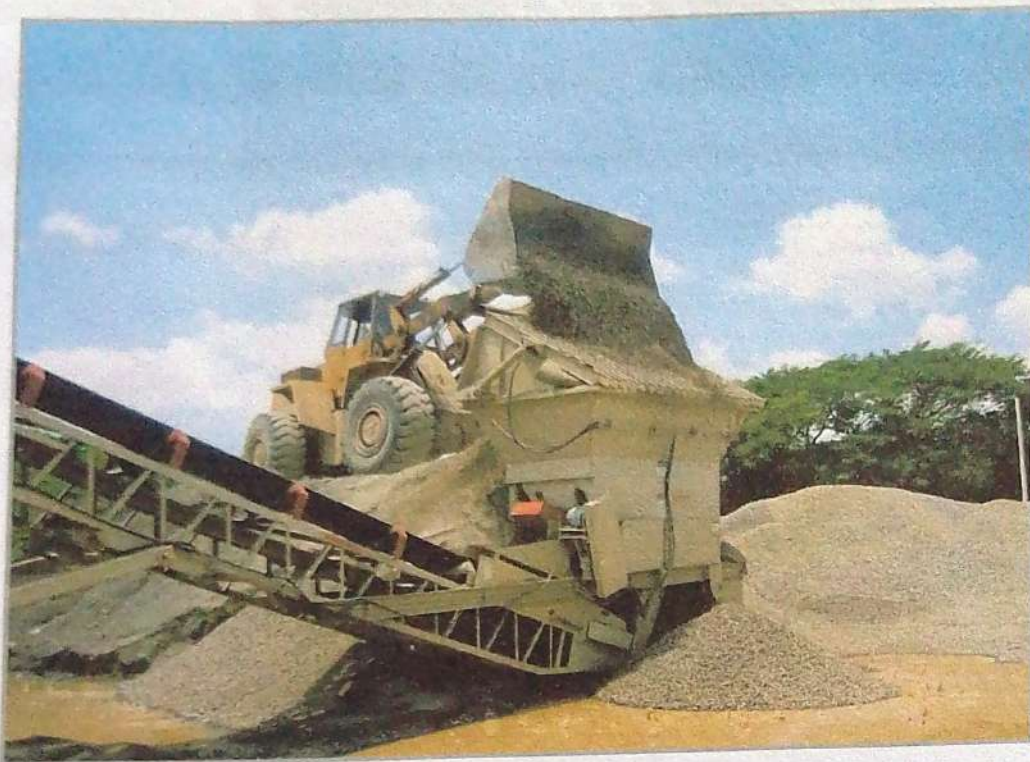
Figura 2.18. Tolva de recepción con rejilla de precibado. Plantel Jiboa, Municipio de Rosario, La Paz.
