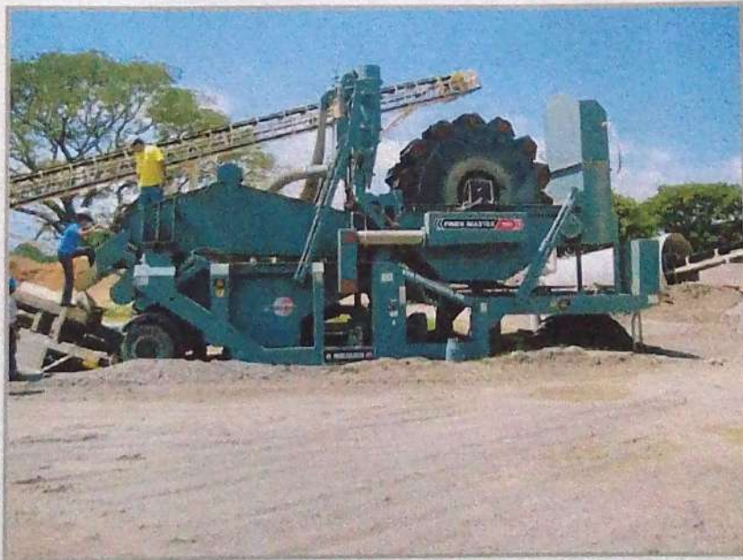
Figura 2.28. Lavadora de arena de cangilones.
