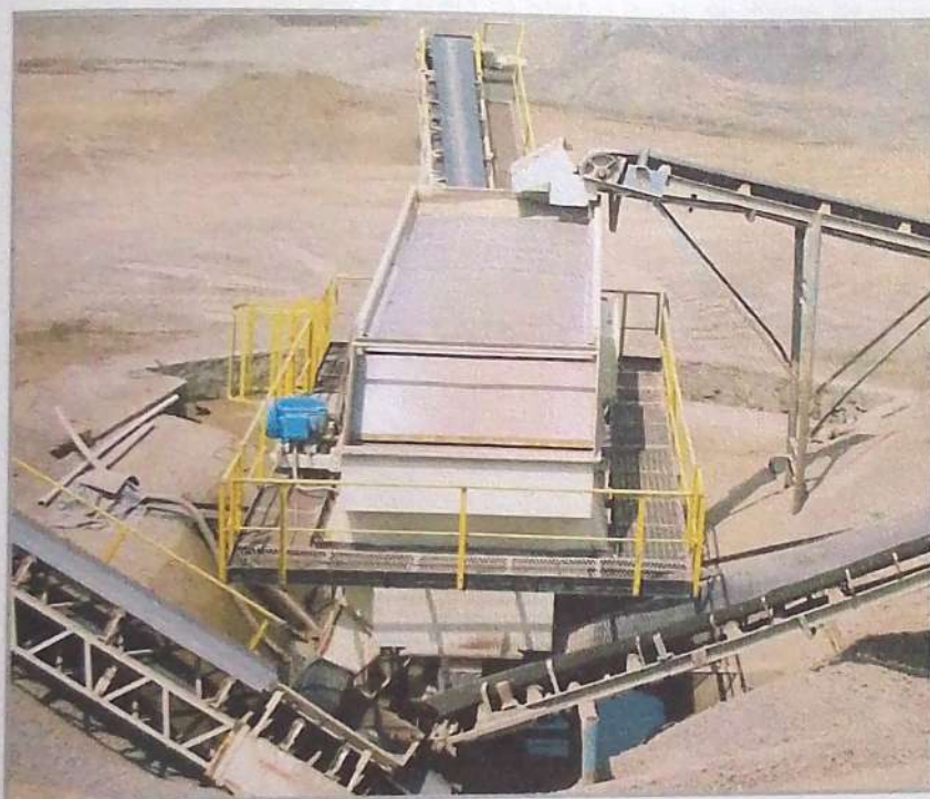
Figura 2.32. El material que proviene de la trituración secundaria es clasificado en la cribadora para luego ser distribuido.
