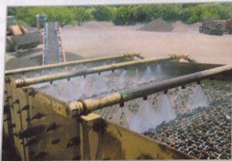
Figura 2.25. Vista superior de la planta portátil de cribado y lavado de agregados. Plantel Jiboa, La Paz.
