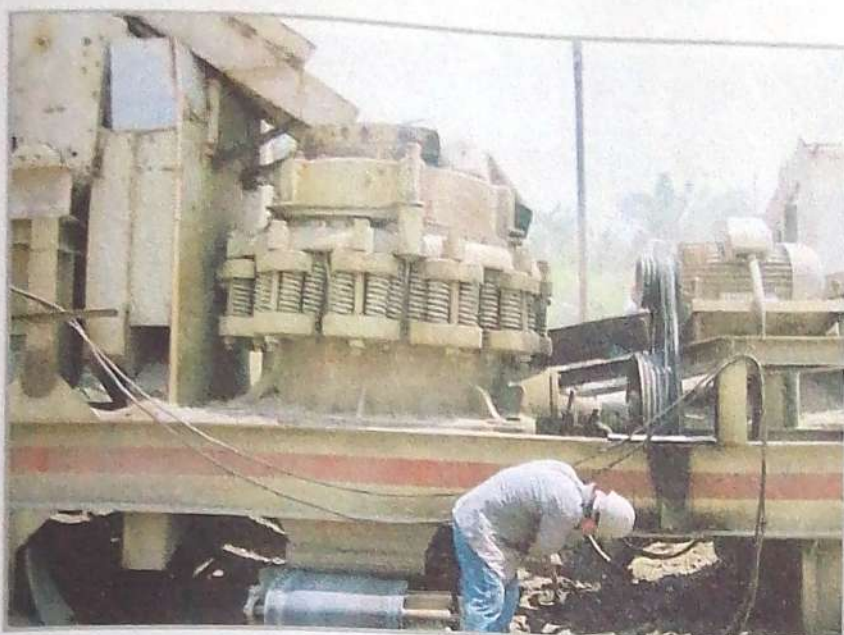
Figura 2.31. Trituradora de cono utilizada en la trituración secundaria.
