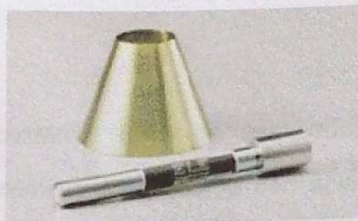
Figura 3.6. Molde y pisón para ensayo de humedad superficial.
