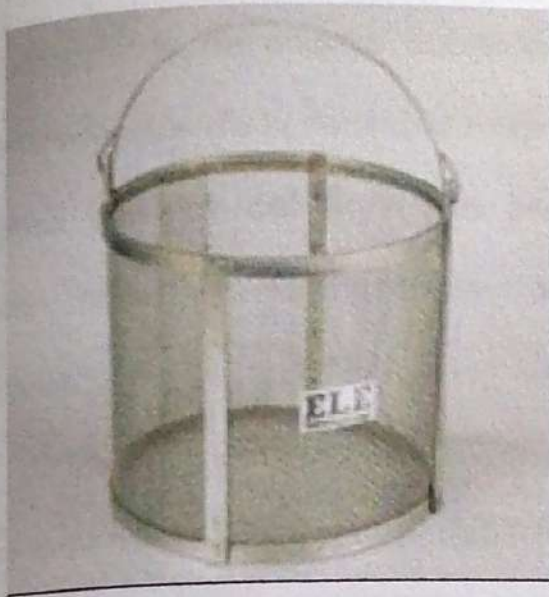
Figura 3.3. Equipo estándar para la determinación de la gravedad específica del agregado grueso.
