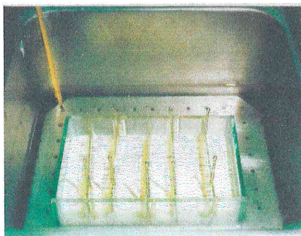
Figura 11. Reactor tipo tanque agitado para utilizar con flujo discontinuo de substrato
