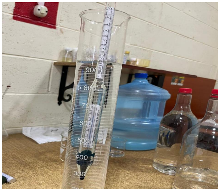
Figura 4. Procedimiento para determinar el grado alcohólico según la temperatura de muestra.
