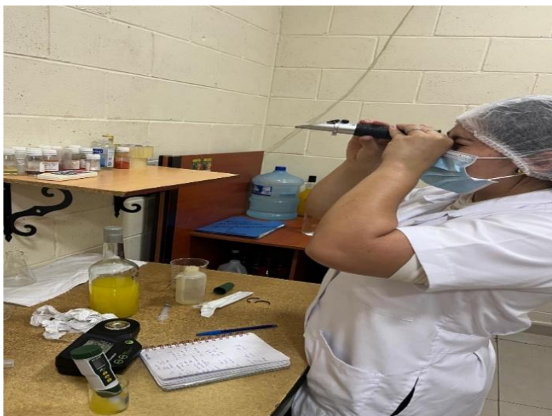
Figura 6. Procedimientos para la determinación del grado alcohólico con alcoholímetro digital
