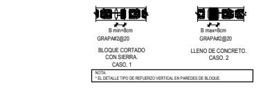
DETALLE DE REFUERZO VERTICAL EN LAS PAREDES CON CORTE DE BLOQUE SIN ESCALA
