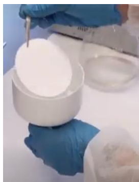
Figura A1.2: Paso 3 del proceso de determinación de densidades SST Y SDT
