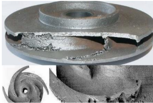
Figura 2.5: Erosión en rodete de bomba rotodinámica con cavitación
