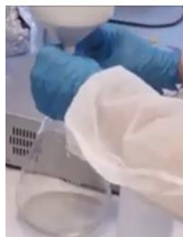
Figura A1.2: Paso 3 del proceso de determinación de densidades SST Y SDT
