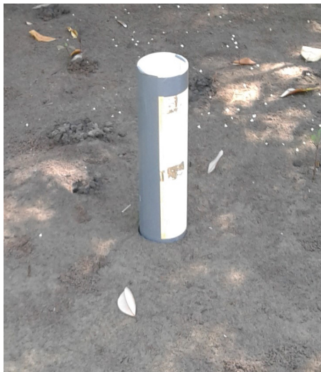
Figura 4.2: Nucleador elaborado de forma artesanal con un tubo de 4 pulgadas de diámetro, afilado en un extremo para facilitar el ingreso al suelo.
