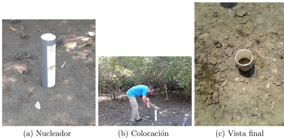
Figura 4.5: Proceso de extracción de muestras.
