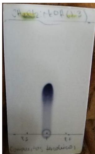
Figura N°13. Cromatografía de capa fina – Compuestos fenólicos. Fuente: Elaboración propia.
