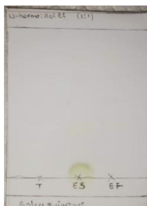
Figura N°8. Cromatografía de capa fina – Antraquinonas. Fuente: Elaboración propia.
