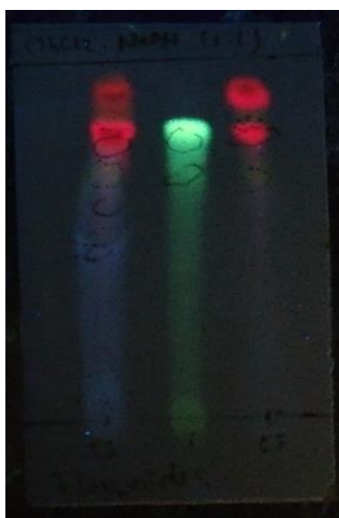
Figura N°14. Cromatografía de capa fina – Glicósidos flavonoides. Fuente: Elaboración propia.
