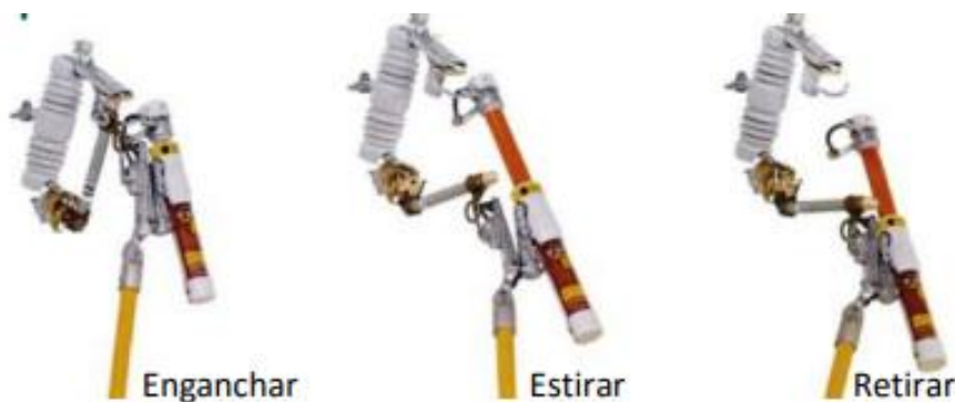
Figura 28: Operación del LoadBuster
