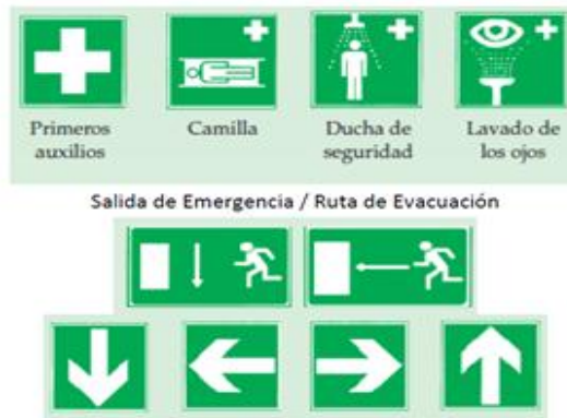
Figura 1. 9 Señales de emergencia
