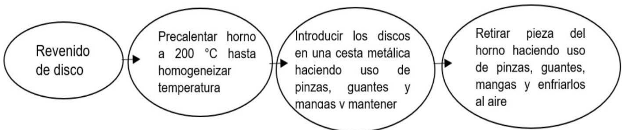
Fig. 2.8. Postratamiento térmico de revenido de discos SAE 1020 previamente templados.
