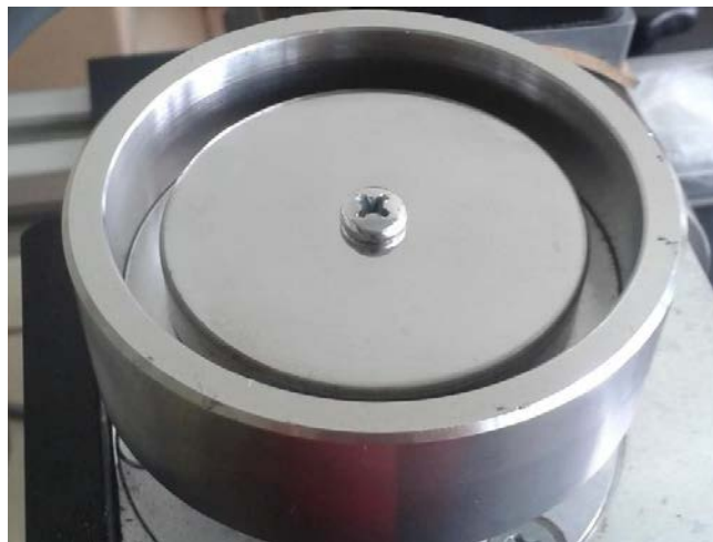
Fig. 2.9. Disco de acero SAE 1020 posterior al proceso de lijado [7].
