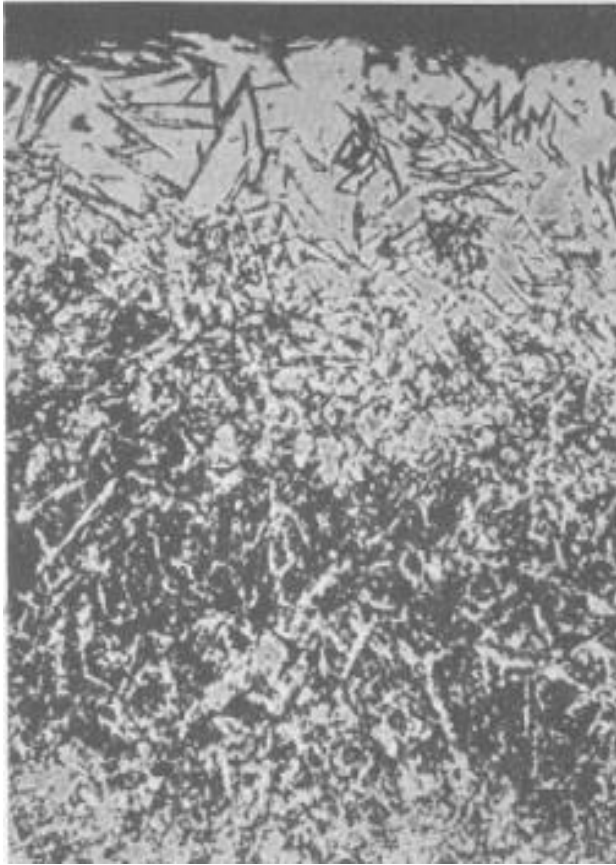
Fig. 1.24. Capa periférica de una pieza cementada y templada de un acero cromo-níquel de la composición siguiente: C = 0.09%, Cr = 0.81% y Ni = 3.10% [3].
