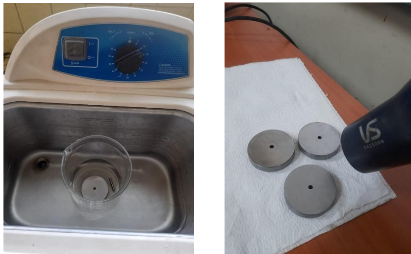
Fig. 2.22. Limpieza en máquina de ultrasonido y secado de disco y espiga previo al ensayo de desgaste.
