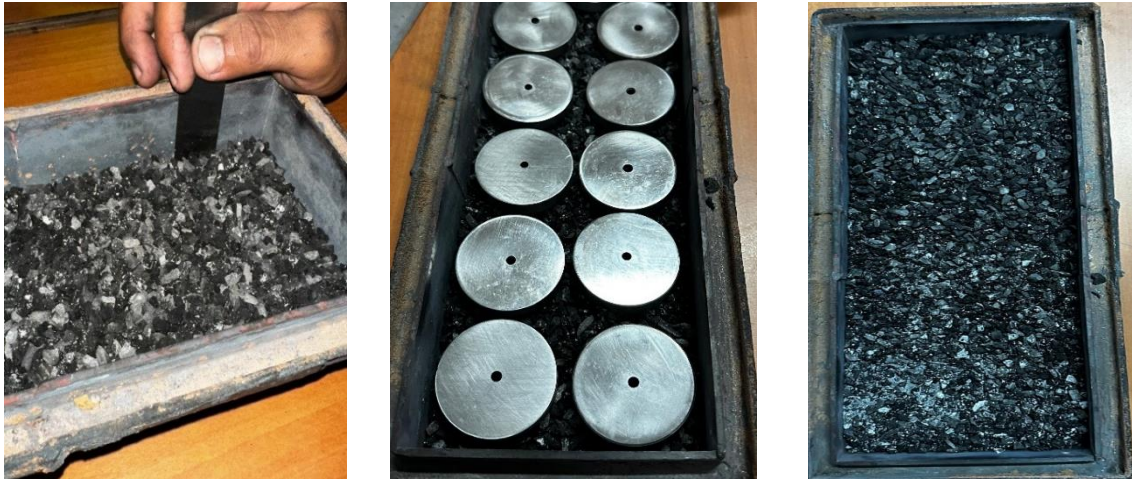
Fig. 2.14. Distribución de probetas y mezcla cementante en la caja de cementación.
