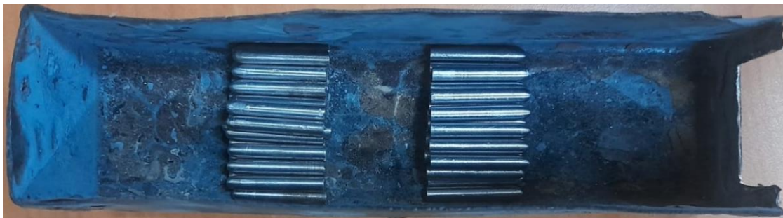
Fig. 2.20. Disposición espigas en la caja para tratamiento térmico de temple y revenido.
