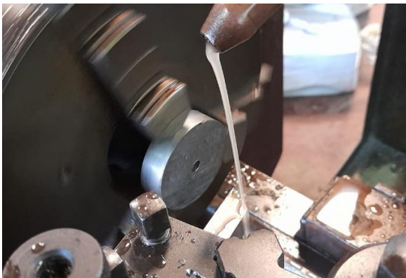
Fig. 2.6. Proceso de refrentado de caras.
