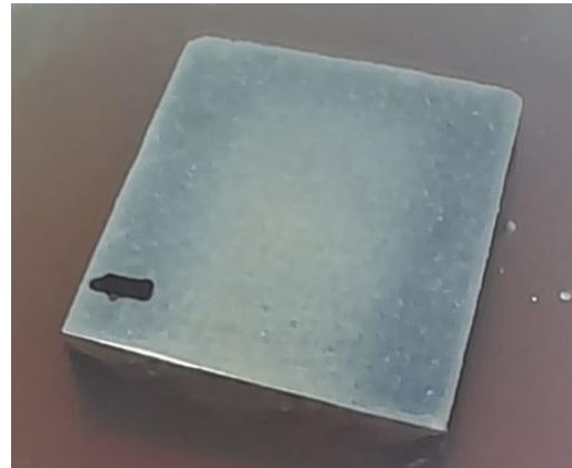
Fig. 2.29. Ataque químico a la muestra.
