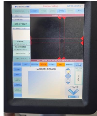
Fig. 2.33. Medición de las diagonales de la huella y lectura de resultados en la pantalla del durómetro.
