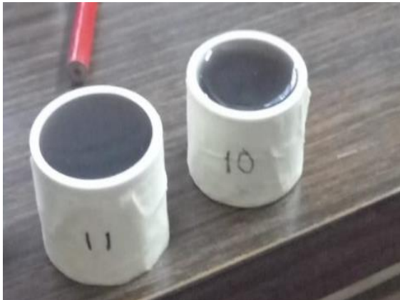
Fig. 2.28. Embutido de muestras.
