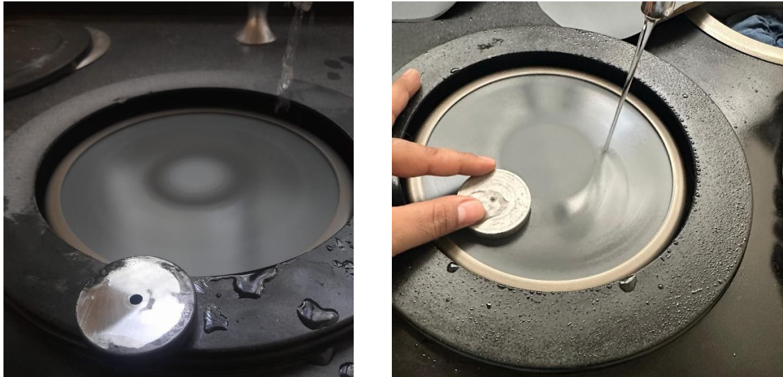
Fig. 2.21. Lijado en mesa rotativa con suministro de agua para enfriamiento.
