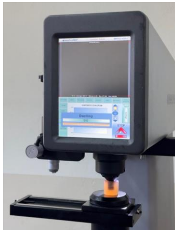
Fig. 2.32. Portamuestra bajo el indenteador durante la aplicación de carga.
