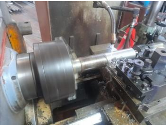
Fig. 2.3. Proceso de cilindrado acero SAE 3115.
