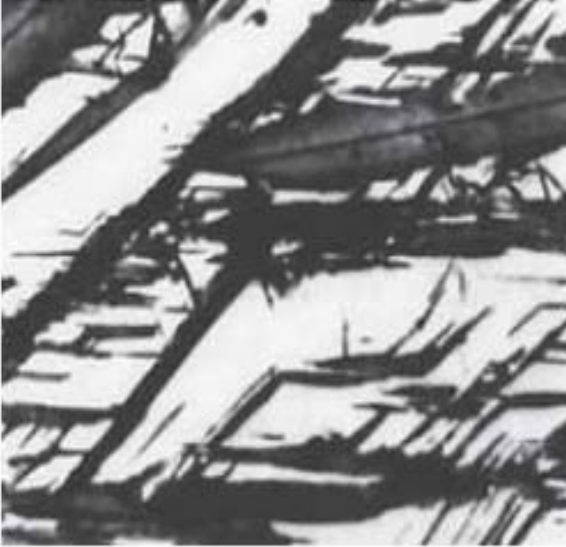
Fig. 1.18. Austenita retenida (blanca) atrapada entre agujas de martensita (negra).
