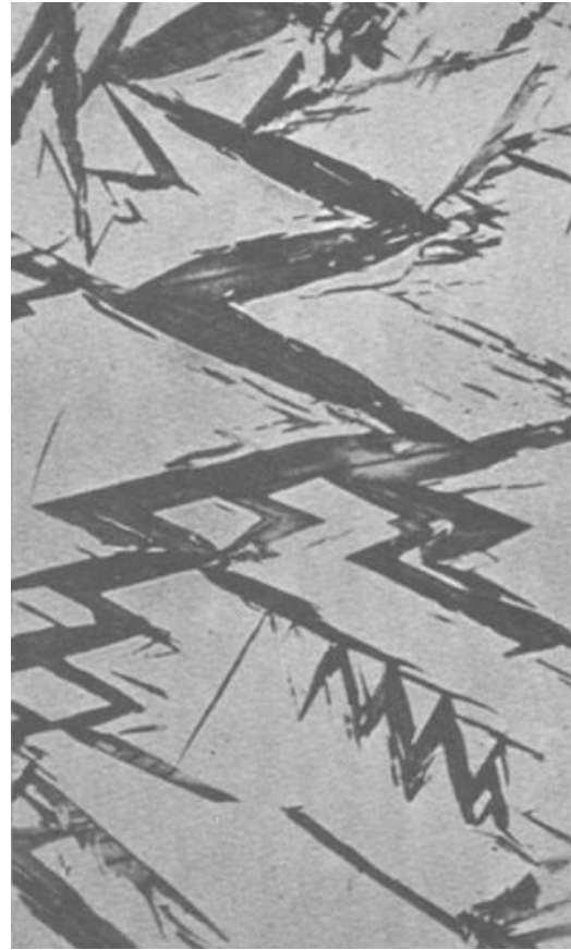
Fig. 1.25. Agujas de martensita sobre un fondo blanco de austenita retenida, correspondientes a la zona periférica del acero de la Fig. 1.24.
