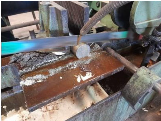
Fig. 2.4. Corte de discos.
