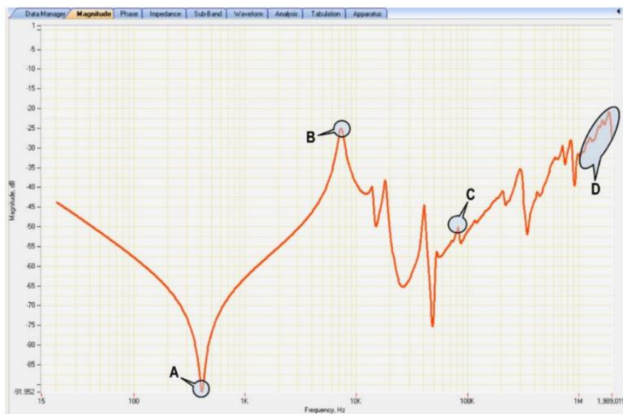
Figura 4. Respuesta en frecuencia típica de un transformador mostrando resonancias y antirresonancias características en el rango de frecuencias de análisis SFRA. Extraído de (CIGRÉ TB 812 Working Group A2.53, 2020)
