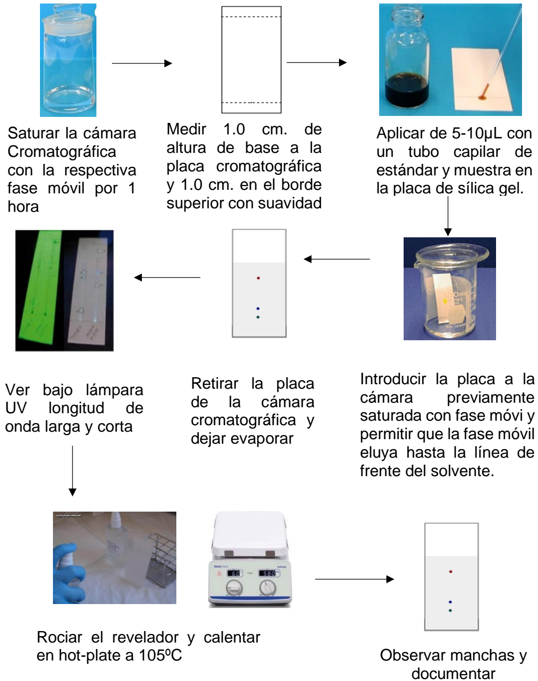
Figura N° 16. Esquema de trabajo de identificación de metabolitos secundarios por Cromatografía en Capa Fina.
