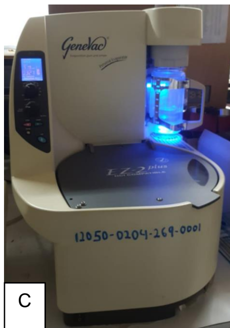
Figura N° 25. (A) Equipo rotavapor. (B) Extracto obtenido al finalizar proceso de rotaevaporación, (C) Equipo Genevac® Ez-2 Evaporator. (D) Equipo liofilizador.
