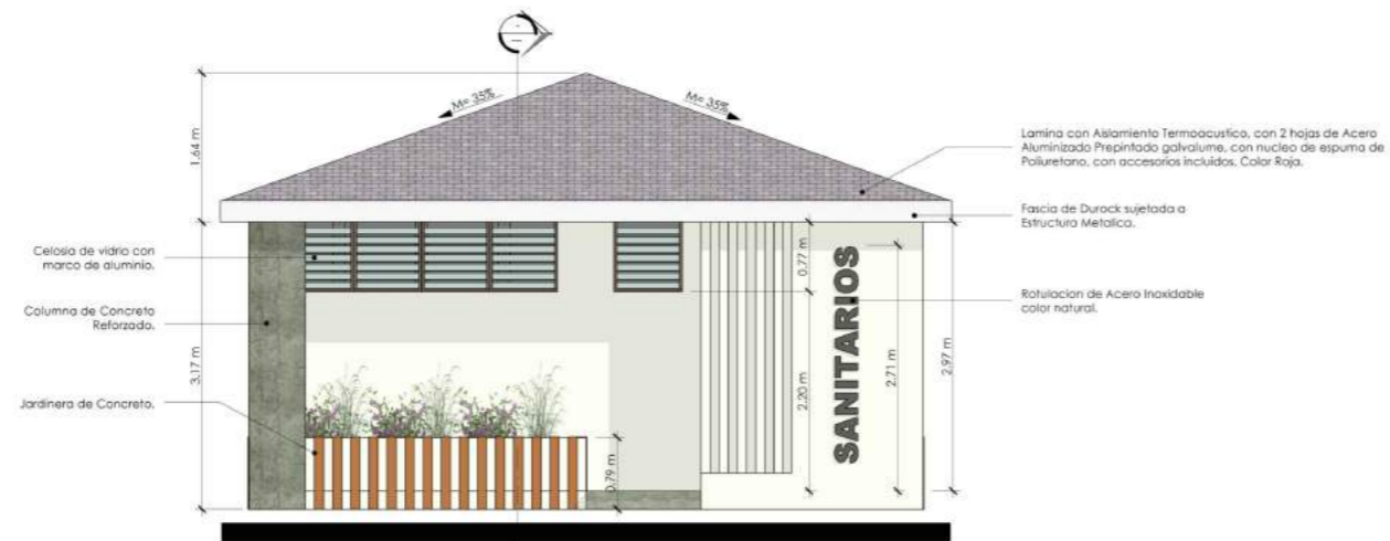
ELEVACION PRINCIPAL BATERIA SANITARIA
