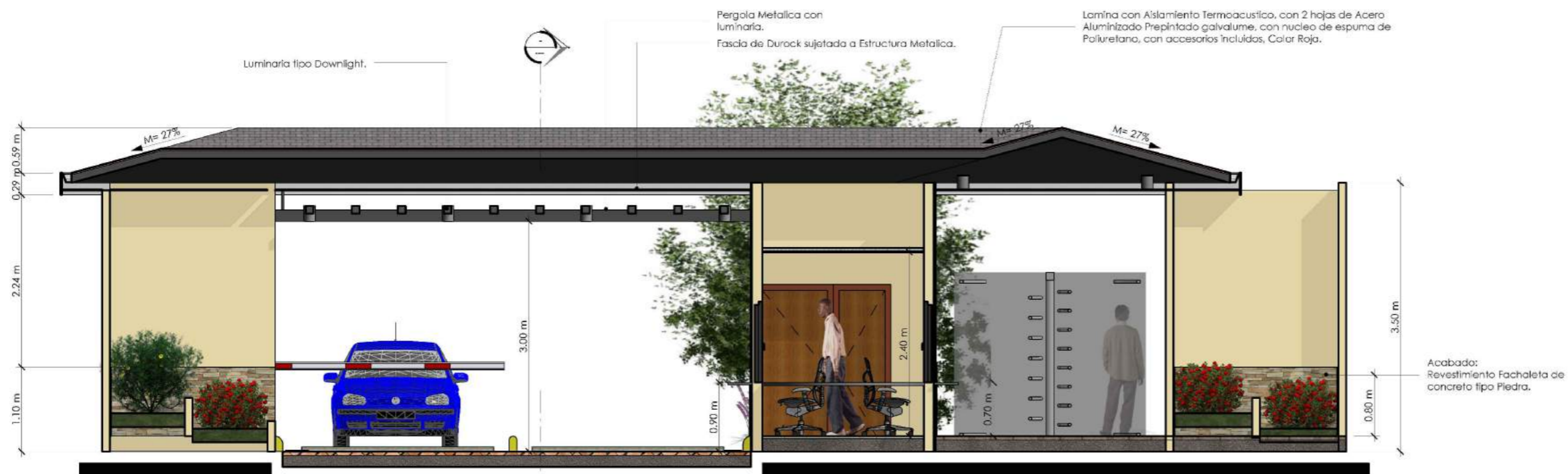
SECCION B-B CASETA DE ACCESO ESCALA 1:75
