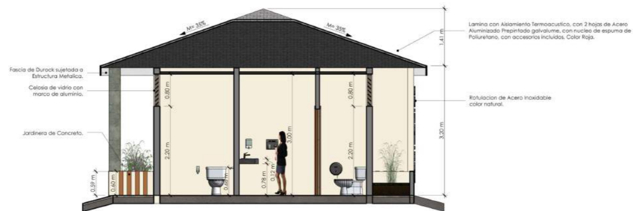
SECCION A-A BATERIA SANITARIA
