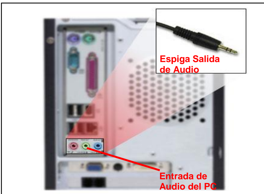
Figura 91. Ubicación de entrada de audio de la computadora.
