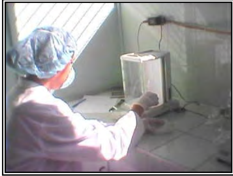
Figura No.6 Pesado de Sólidos en Balanza Analítica
