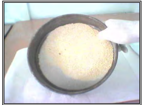
Figura No.4 Tamización de mesocarpo por tamiz #100
