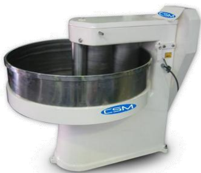
Sin Guarda Seguridad
