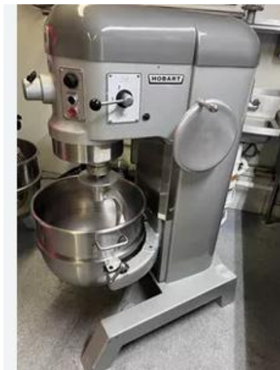
Sin Guarda Seguridad
