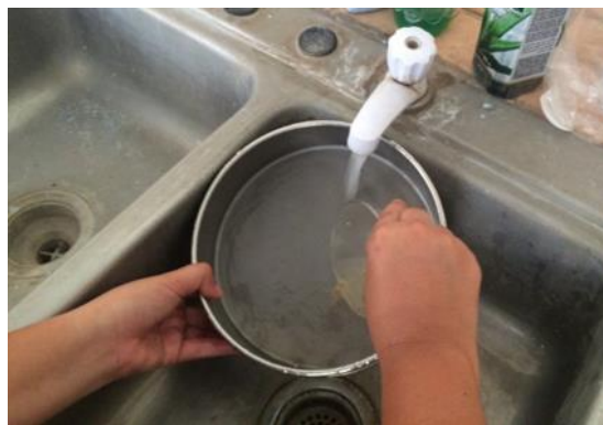
Figura 29. Decantación de la muestra sobre tamiz de 500 mesh.
