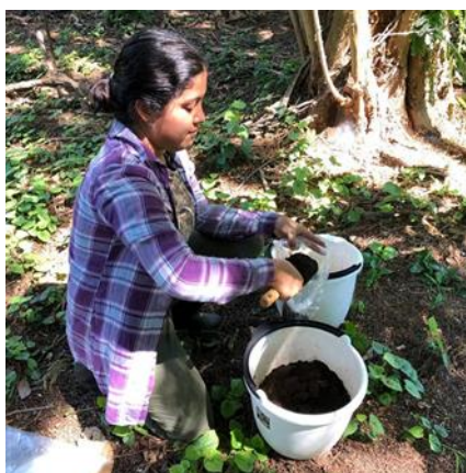
Figura 13. Colocación de la muestra en una bolsa plástica (Sitio 3).
