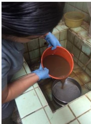
Figura 20. Decantación de la muestra en dos tamices de 325 mesh.
