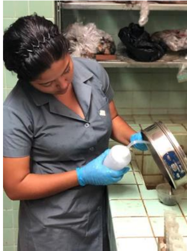
Figura 21. Colocación de la muestra en una taza evaporadora con ayuda de una pizeta.
