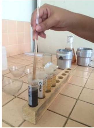
Figura 26. Mezcla del precipitado con la solución azucarada.
