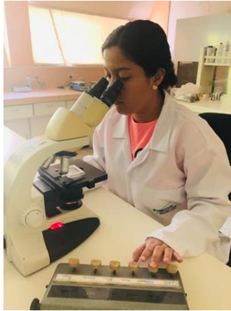
Figura 37. Identificación y cuantificación de los nematodos en cámara de recuento al microscopio con ayuda de un contómetro.
