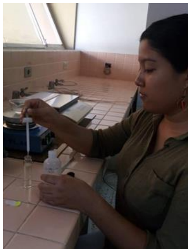
Figura 34. Agregación de formalina a la muestra.
