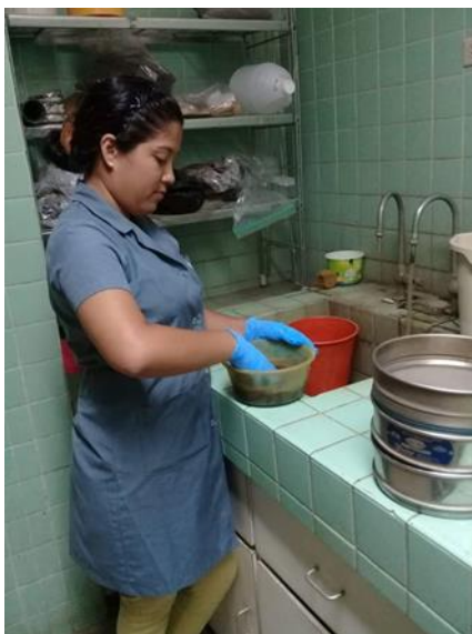
Figura 17. Eliminación de grúmulos de suelo de la muestra en un recipiente de plástico.
