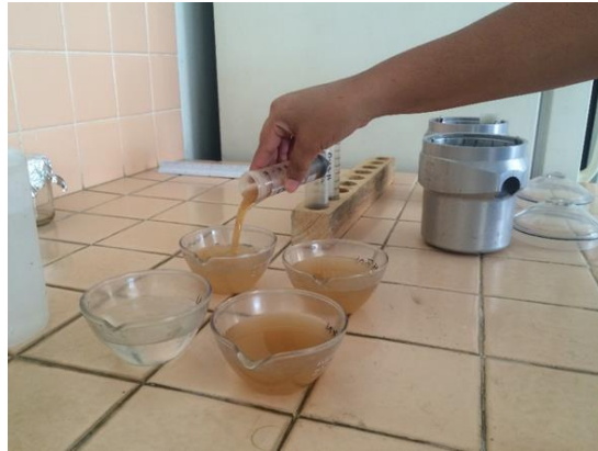
Figura 28. Colocación del sobrenadante en tazas evaporadoras con agua.
