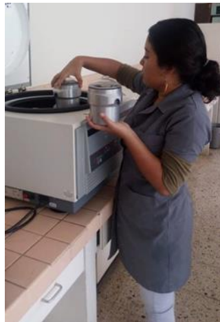
Figura 27. Centrifugación de muestras por minuto y medio.
