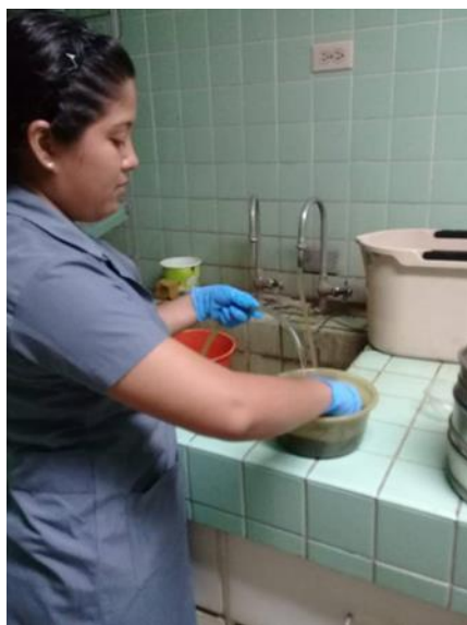
Figura 18. Colocación de agua del grifo a la muestra, para su posterior reposo.
