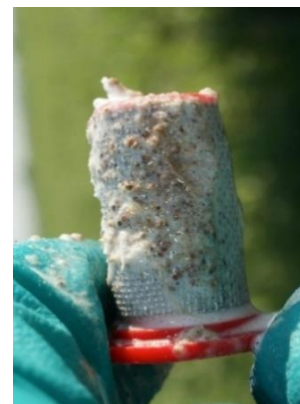
Figura 27. Taponamiento de filtros de los equipos de aplicación por incompatibilidad de productos
