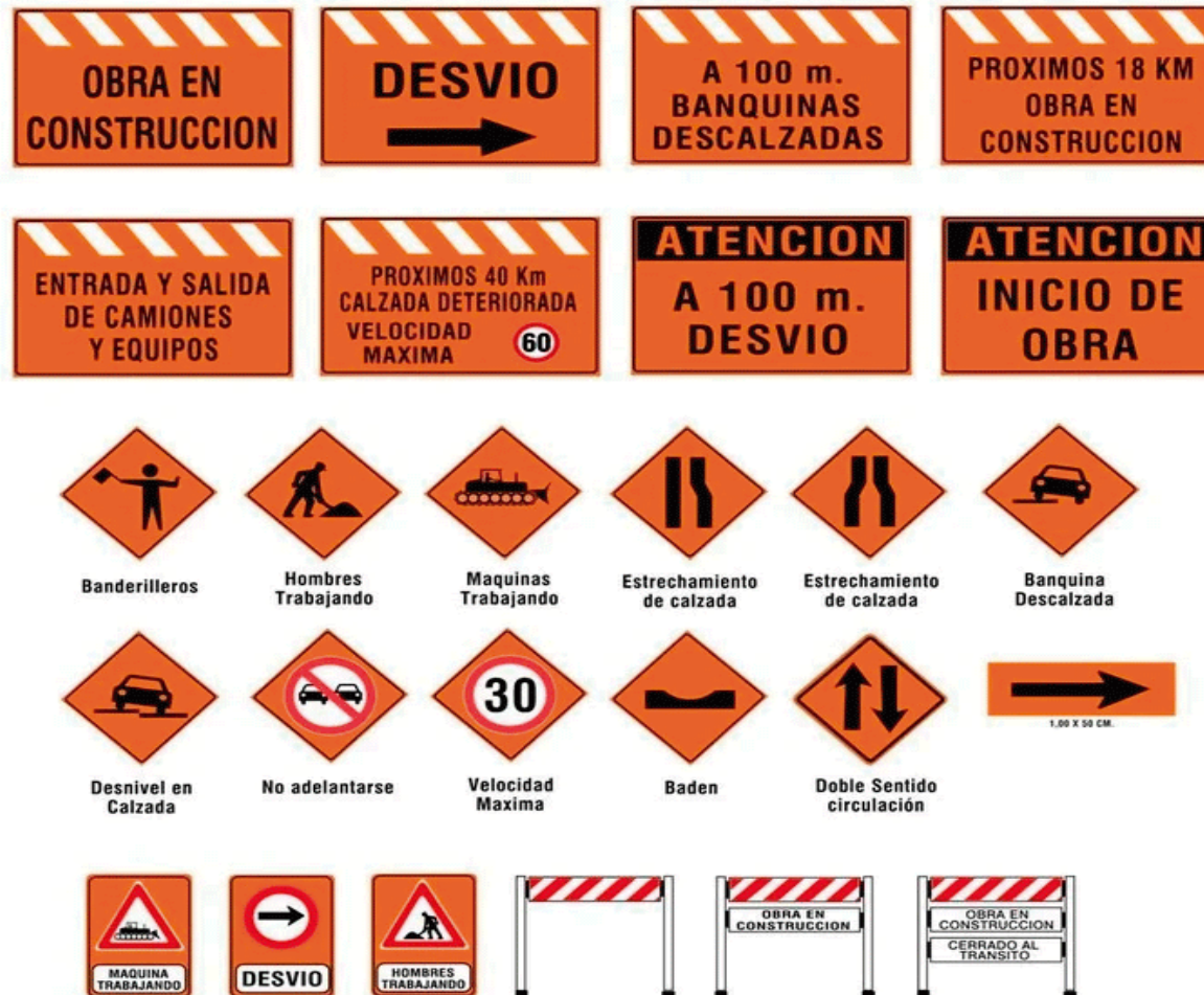
IMAGEN N° 6 SEÑALIZACION A UTILIZAR EN LA OBRA
